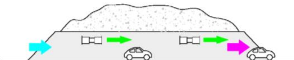
Slika 21: Shematski prikaz uzdužne ventilacije sa impulsnim aksijalnim ventilatorima [23]
