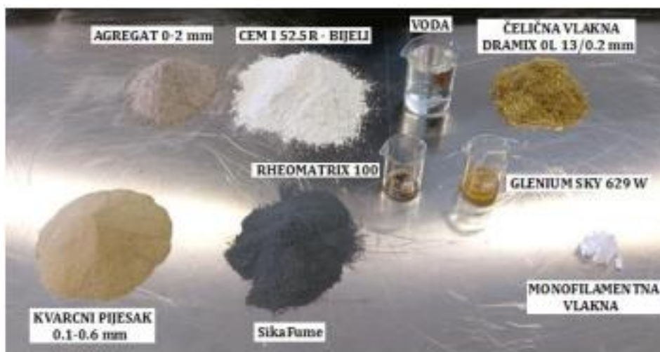
Slika 8: Sastavne komponente hibridnog mikroarmiranog betona [8]
