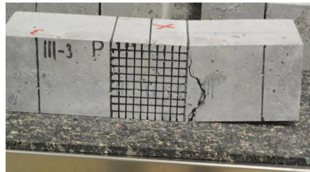
Slika 22: Položaj pukotine s prednje strane (lijevo) i sa stražnje strane (desno) za uzorke S1,5–MF0,1 mješavine [22]
