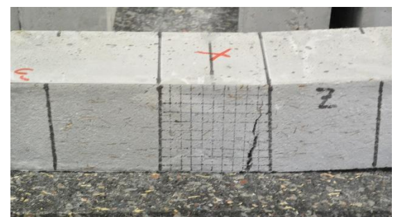
Slika 30: Položaj pukotine s prednje strane (lijevo) i sa stražnje strane (desno) za uzorke S1,5–MF0,3 mješavine [30]
