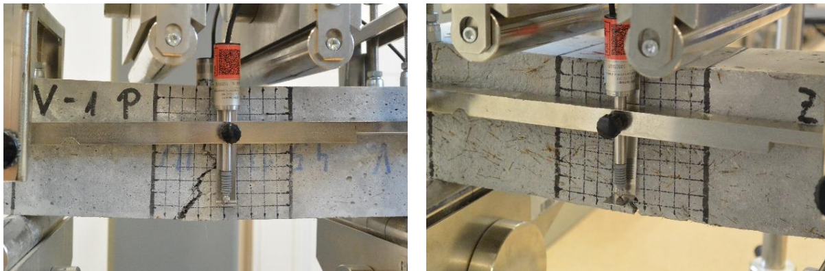
Slika 29: Duktilni slom uzorka mješavine S1,5-MF0,3 [29]
