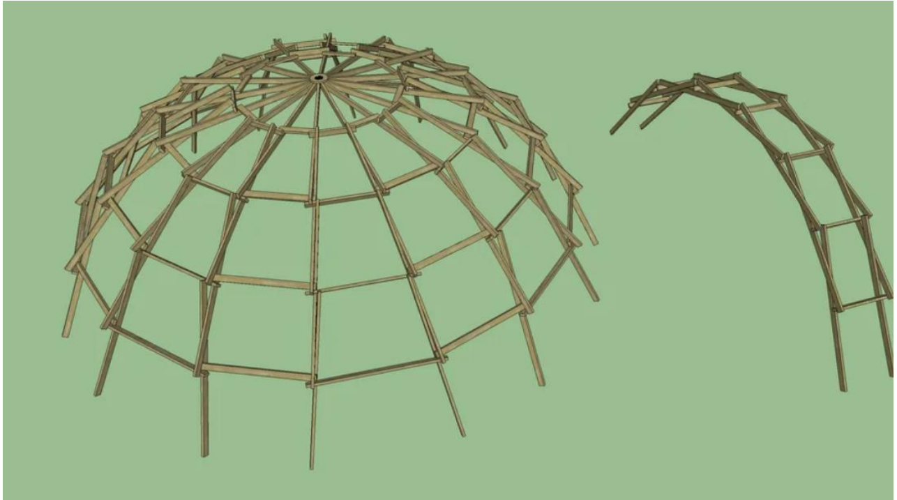
Slika 4: Kupolni okvir zasnovan na modificiranom mostu Leonarda da Vincija.
