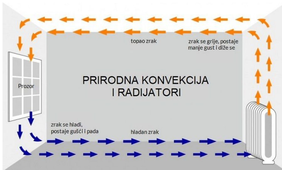
Slika 13: Prirodna konvekcija na primjeru radijatora [11]
