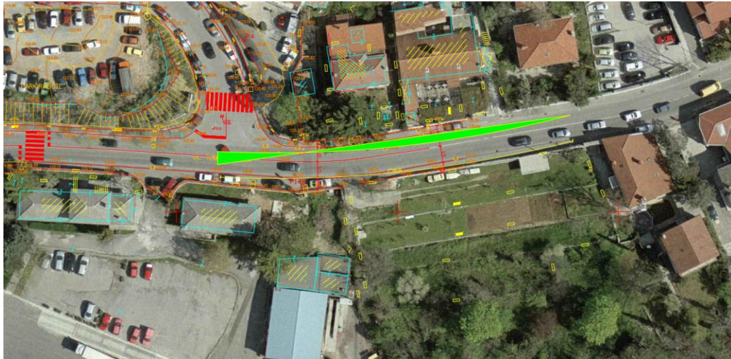
Slika 13. Preglednost SAD glavni smjer skretanje u lijevo na sporedni smjer
