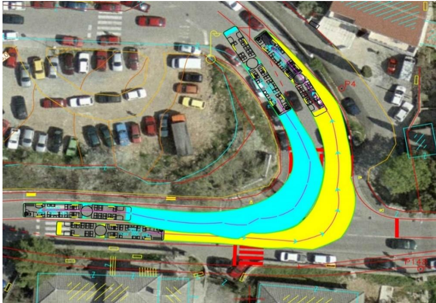
Slika 24. Provoznost vozila lijevi sa GP. i desni sa SP
