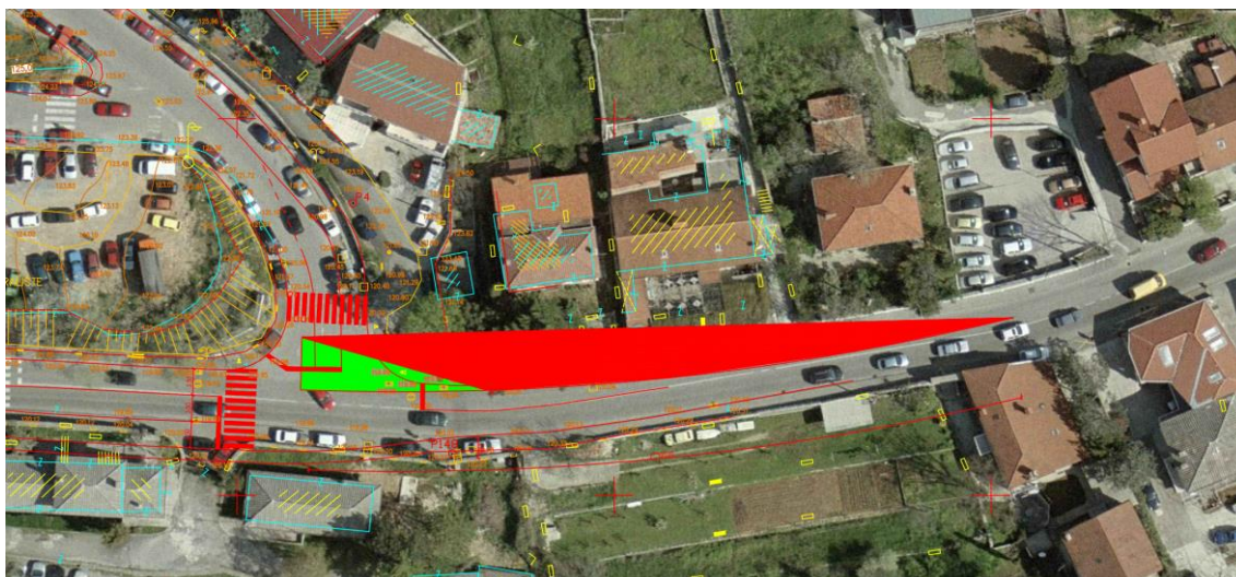
Slika 22. Preglednost SAD norme sporedni smjer skretanje u desno
