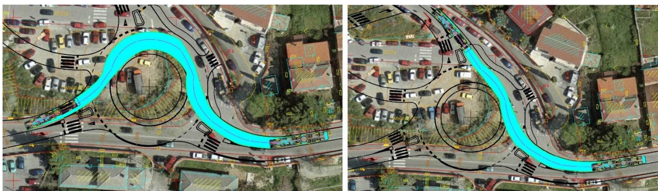
Slika 54. Provoznost vozila sa Kačjaka na Kampus i u Grad
