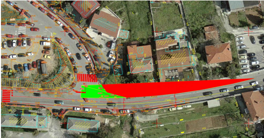
Slika 12. Preglednost SAD norme sporedni smjer skretanje u desno
