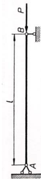
Slika 6.1. Zglobno vezani štap na oba kraja za izračun kritične Eulerove sile
