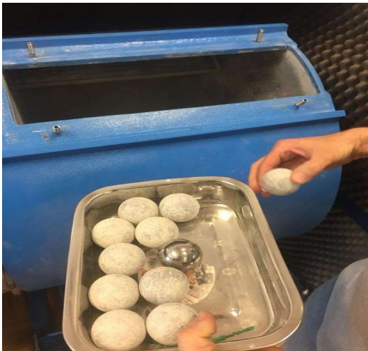
Slika 18: Postavljanje kugli u bubanj [18]
