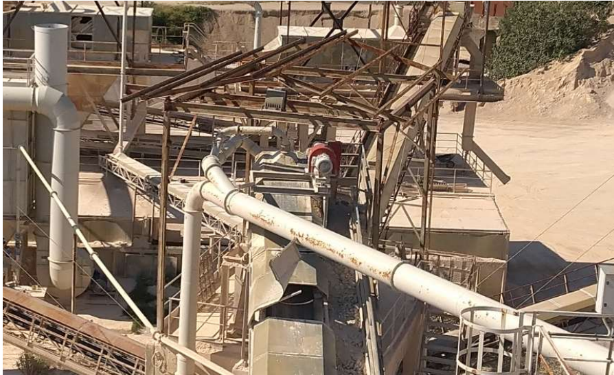
Slika 7: Glavno sito u kojeg se materijal dovozi pomoću pokretnih traka i prosijava (fotografirao autor)
