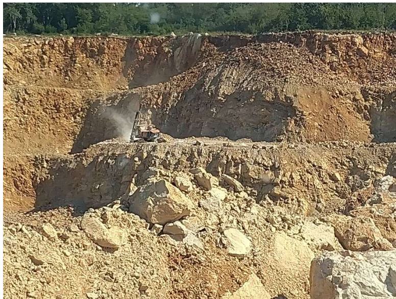
Slika 1: Bušenje rupa za miniranje. (fotografirao autor)
