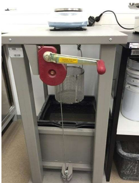
Slika 13: Uređaj za vaganje pod vodom s mrežastom košarom [18]
