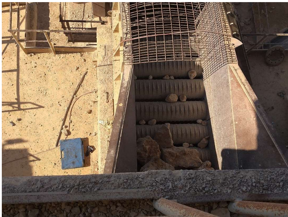
Slika 3: Valjci na kojima se materijal razvrstava prije ulaska u drobilicu (fotografirao autor)
