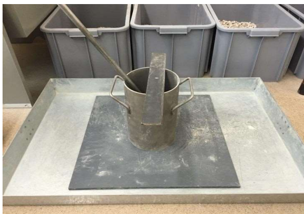
Slika 16: Posuda za mjerenje, šipka za nabijanje i ravnjača [18]
