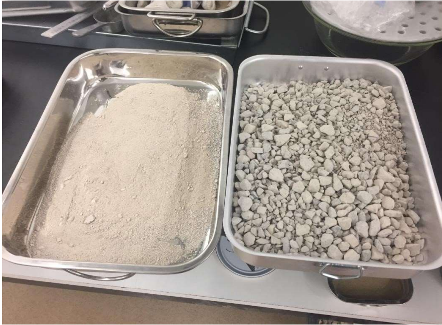
Slika 17: Agregat nakon prosijavanja podijeljen na frakcije [18]
