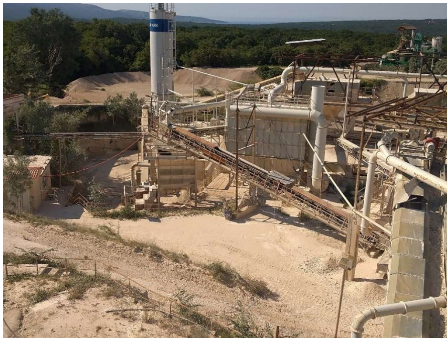
Slika 8: Pokretna traka odvodi materijal na daljnje usitnjavanje (fotografirao autor)
