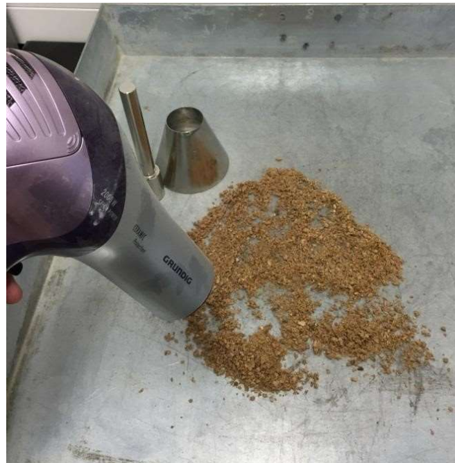
Slika 15 : Sušenje električnim puhalom [19]
