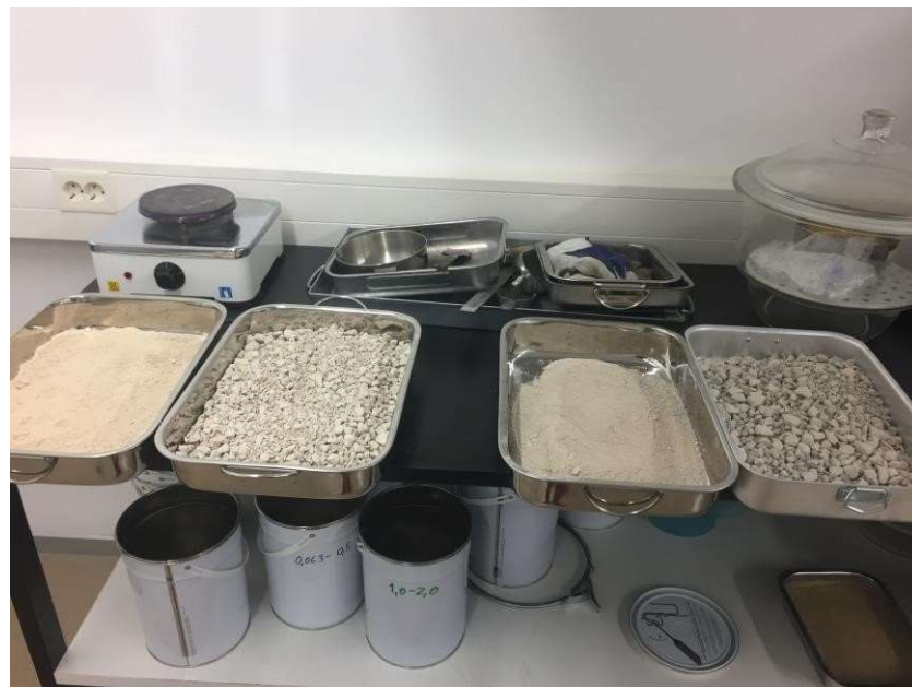
Slika 21: Prosijani agregat nakon izlaska iz bubnja [18]
