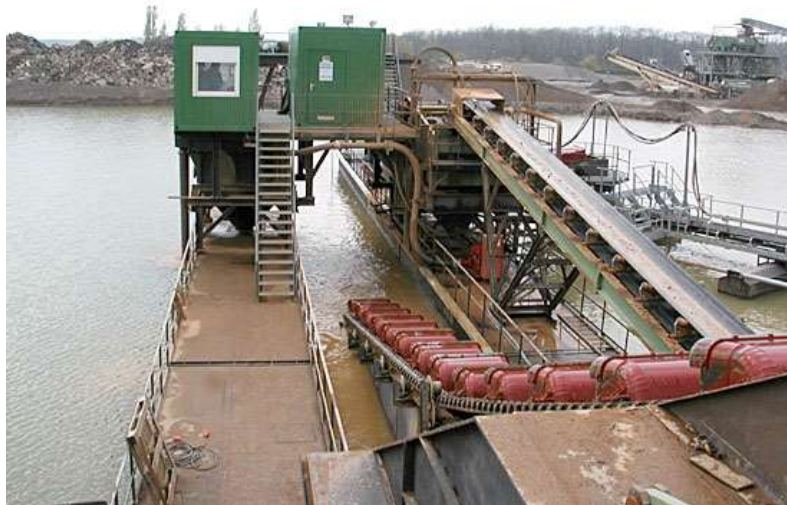
Slika 10 : Vjedrični plovni bager sa vedrima za vađenje pijeska i šljunka [13]
