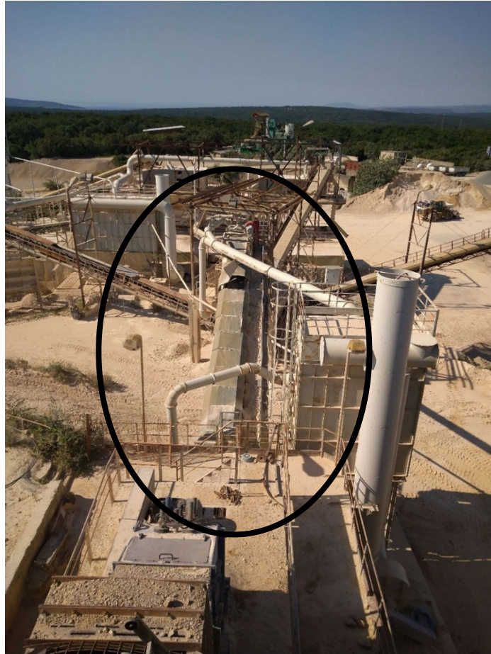
Slika 6: Pokretna traka koja vodi materijal do glavnog sita (fotografirao autor)
