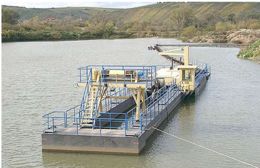
Slika 11: Plutajući usisni bageri sa iskopno/transportnim lancem za iskop pijeska i sitnijeg šljunka [13]
