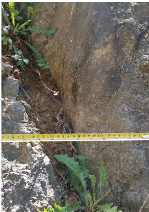
Slika 17. Detalj izgleda diskontinuiteta na lokaciji T2. Diskontinuitet je ispunjen debelom glinovitom ispunom. Vidljiva je glatka površina stijenske diskontinuiteta (Fotografija: Filip Marfan).
