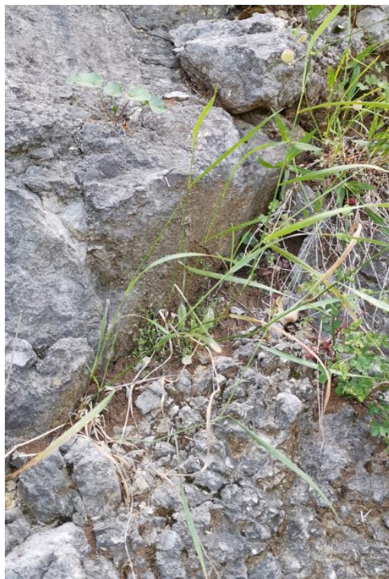
Slika 15. Detalj značajki diskontinuiteta na lokaciji T1. Vidljiva je glinovita ispuna, te relativno glatka stijenka diskontinuiteta (Fotografija: Filip Marfan).
