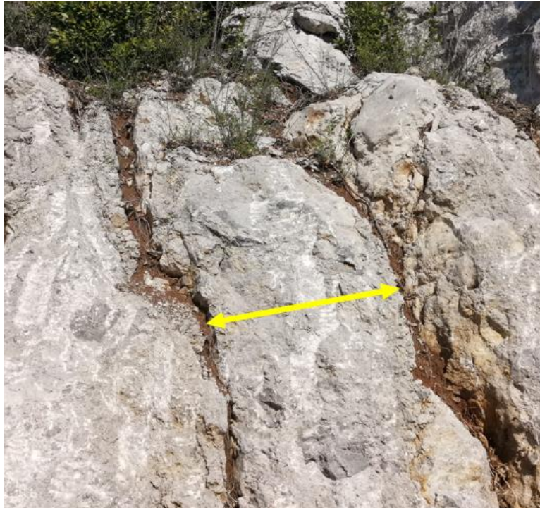
Slika 8. Razmak između diskontinuiteta (fotografija: Filip Marfan).
