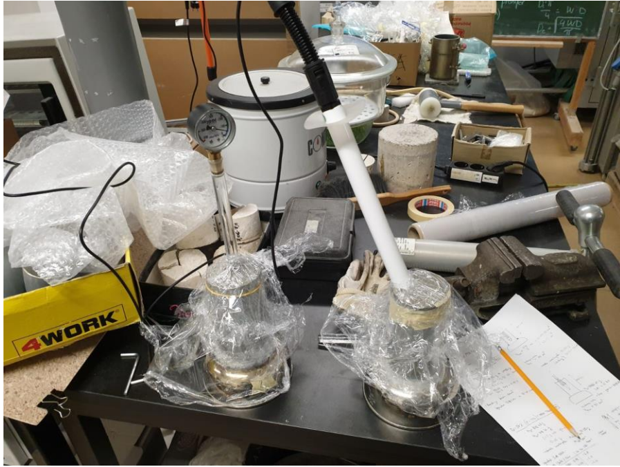
Slika 35: Uzorak s ugrađenim stabdardnim T1 tenziometrom (lijevo) i uzorak s ugrađenim TEROS 32 tenziometrom (desno)
