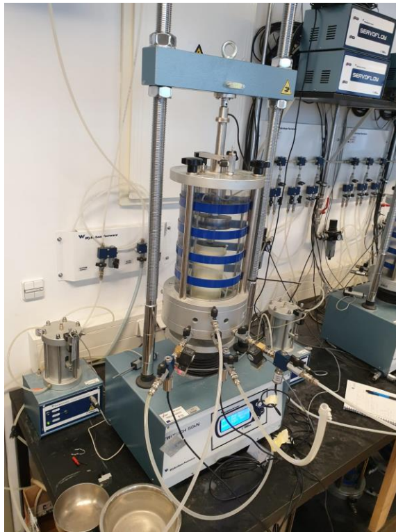
Slika 38: Prikaz ćelije za vrijeme mjerenja krivulje retencije
