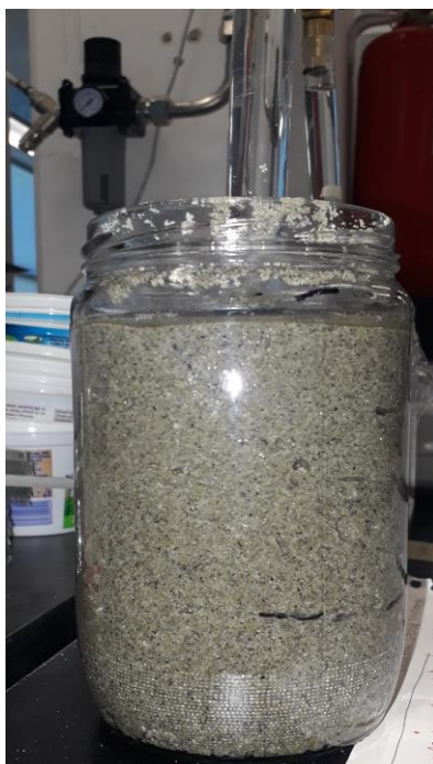
Slika 33: Pojava slobodne vode na uzorku pijeska s ugrađenim standardnim T1 tenziometrom
