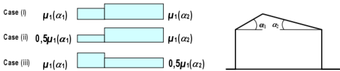
Slika 2. Koeficijenti oblika opterećenja snijegom za dvostrešni krov
