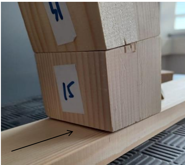
Slika 39. Uvećani prikaz otvorenih zglobova pri sili od 23 N
