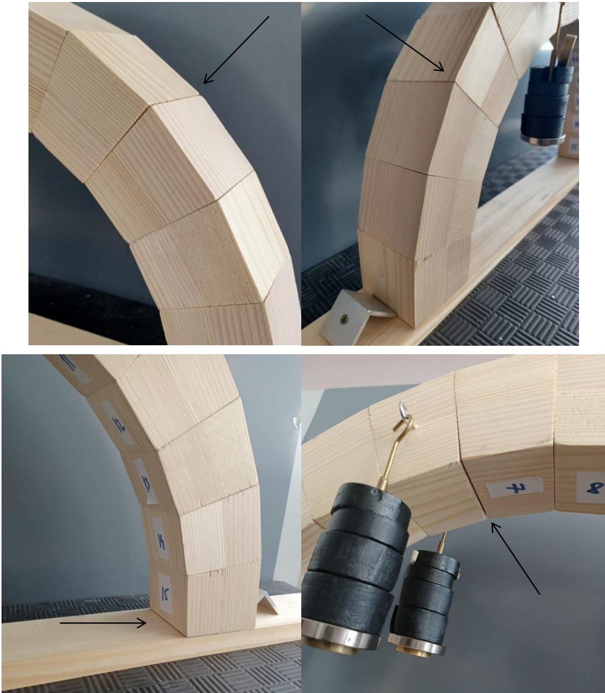
Slika 37. Uvećani prikaz otvorenih zglobova pri sili od 16,5 N
