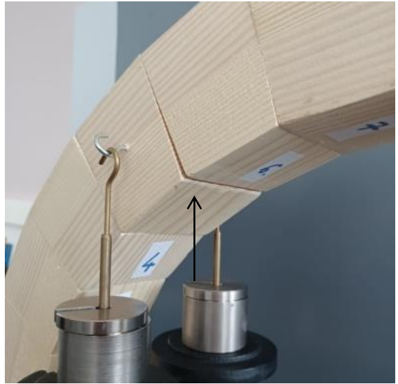
Slika 39. Uvećani prikaz otvorenih zglobova pri sili od 23 N
