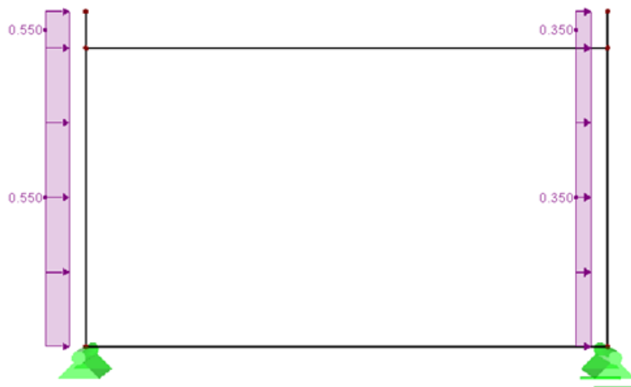
Slika 26: Prikaz 2D proračunskog modela sa opterećenjem vjetra kada puše na uzdužnu stranu objekta
