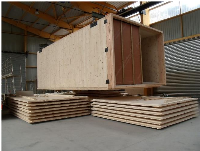
Slika 6: Drvene prstenaste ćelije [4]
