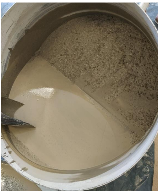
Slika 12 Izgled mješavine 2 (SCC SF0,5)
