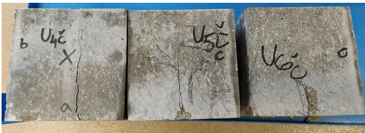
Slika 37 Slom uzoraka prilikom nanošenja vlačne sile cijepanjem mješavine 2
