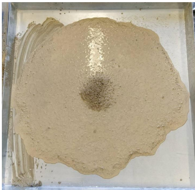
Slika 18 Ispitivanje rasprostiranja mješavine 2
