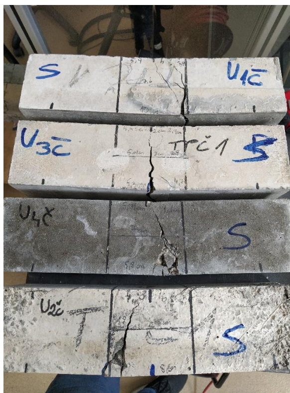
Slika 48 Slom uzoraka mješavine 2
