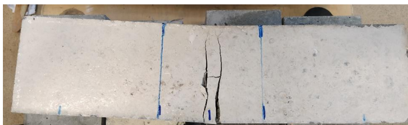
Slika 52 Slom uzorka mješavine 4
