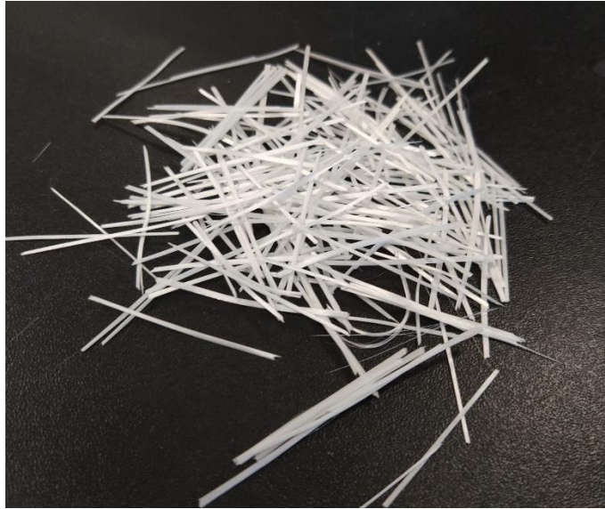
Slika 9 Staklena vlakna Anti-crack HP 67/36
