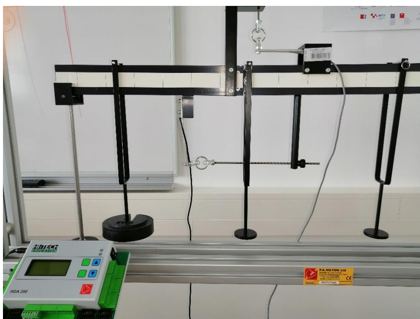
Slika 14-Greda opterećena sa 10N na vješalici za utege W1.
