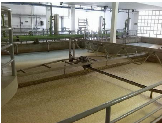
Slika 14.: Koagulacija, flokulacija i flotacija, PKV Butoniga [12]
