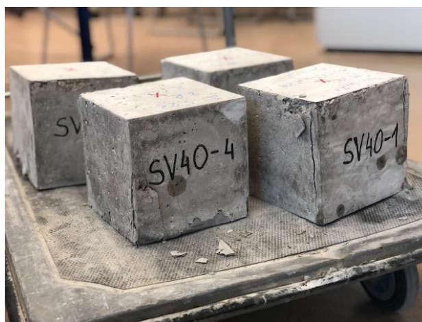
Slika 32: Tipični oblik sloma uzoraka kocke s dodatkom PP vlakana 18 mm i 40 mm (SV40) ispitani na tlak
