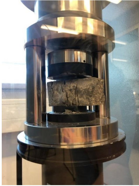
Slika 33: Ispitivanje vlačne čvrstoće betona na tlak, male prizme
