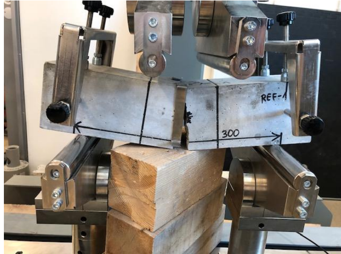
Slika 19: Ispitivanje vlačne čvrstoće betona savijanjem, referentna mješavina (krti slom)
