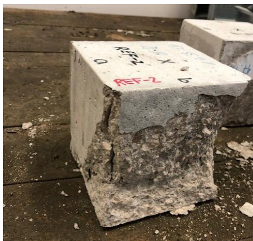
Slika 30: Tipični oblik sloma uzorka kocke referentne mješavine ispitanoj na tlak
