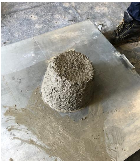
Slika 16: Ispitivanje rasprostiranjem za normalni beton, mješavina SV50
