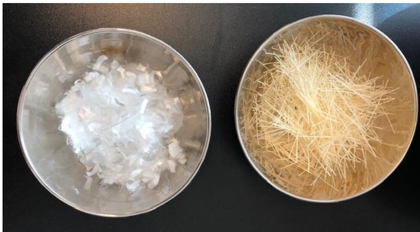
Slika 8: Mikrosintetička vlakna duljine 18 mm i makrosintetička vlakna duljine 50 mm
