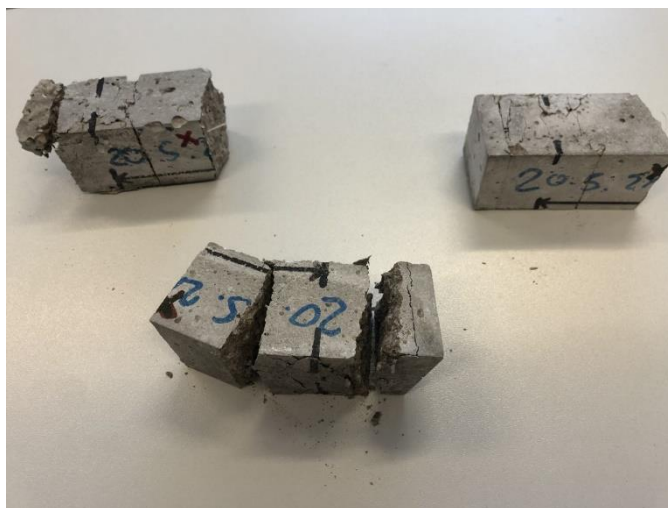
Slika 34: a) Tipični oblik sloma uzorka REF mješavine; b) Tipični oblik sloma uzorka SV50 mješavine
