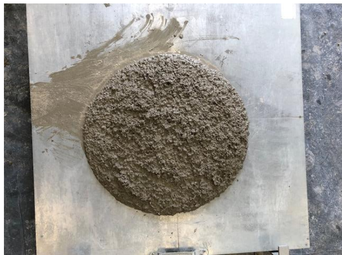
Slika 17: Rezultat ispitivanja rasprostiranjem za normalni beton nakon potresanja ploče, mješavina SV50
