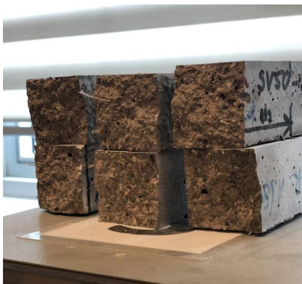
Slika 28: Uzorci malih prizmi ispitani na vlak savijanjem
