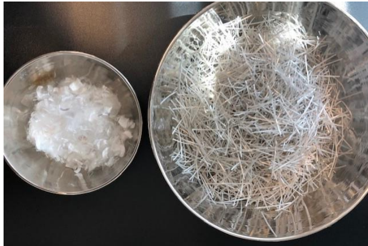
Slika 10: Mikrosintetička vlakna duljine 18 mm i makrosintetička vlakna duljine 40 mm
