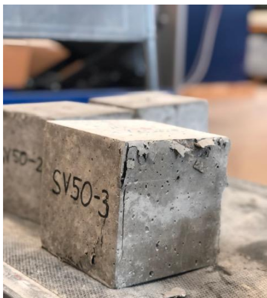
Slika 31: Tipični oblik sloma uzorka kocke s dodatkom PP vlakana 18 mm i 50 mm (SV50) ispitanoj na tlak
