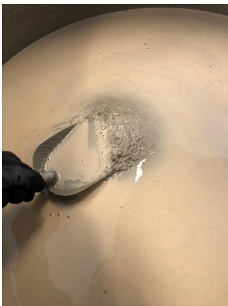
Slika 4: Problem izdvajanja vode u probnoj mješavini
