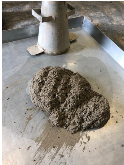
Slika 15: Rezultat ispitivanja rasprostiranja slijeganjem za samozbijajući beton, mješavina SV50
