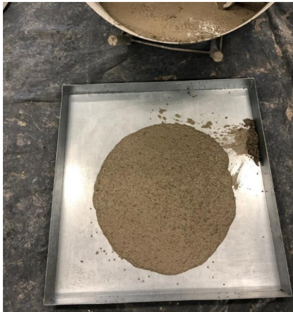
Slika 14: Rezultat ispitivanja rasprostiranja slijeganjem na velikoj ploči
