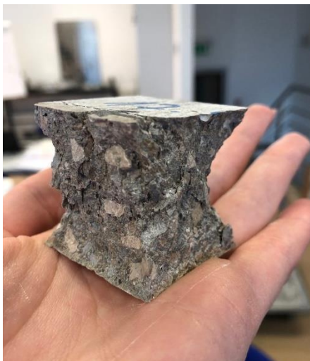
Slika 34: a) Tipični oblik sloma uzorka REF mješavine; b) Tipični oblik sloma uzorka SV50 mješavine
