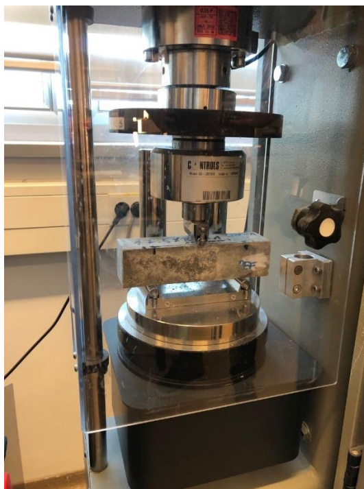
Slika 27: Ispitivanje vlačne čvrstoće betona savijanjem, male prizme
