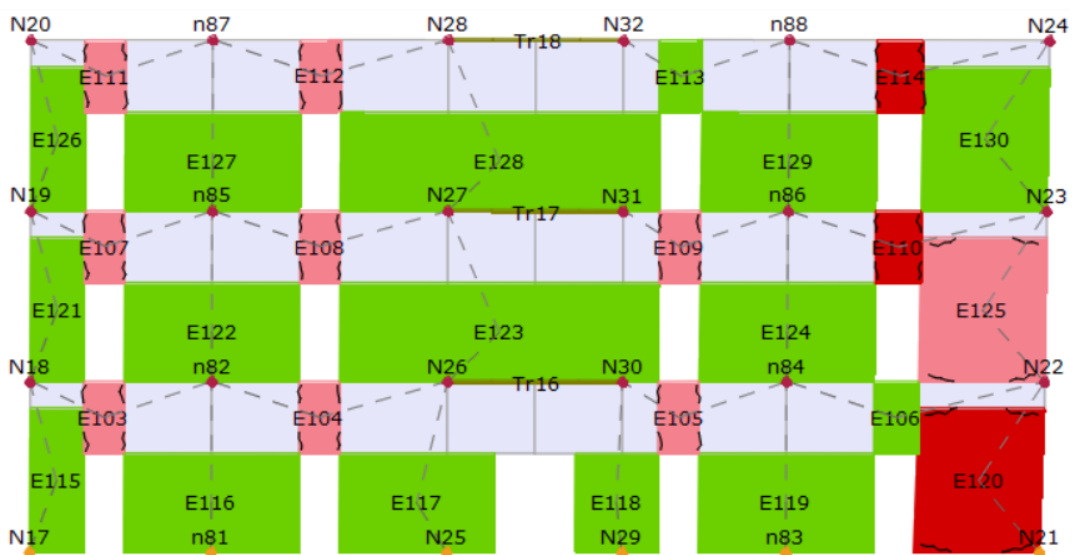
Slika 61: Oštećenja i slomovi makroelemenata u karakterističnom zidu u trenutku sloma prvog konstruktivnog elementa X smjera
