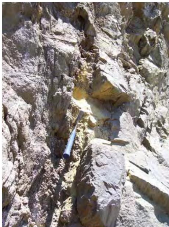
Slika 20. Stupanj uslojenosti – primjer 3.
