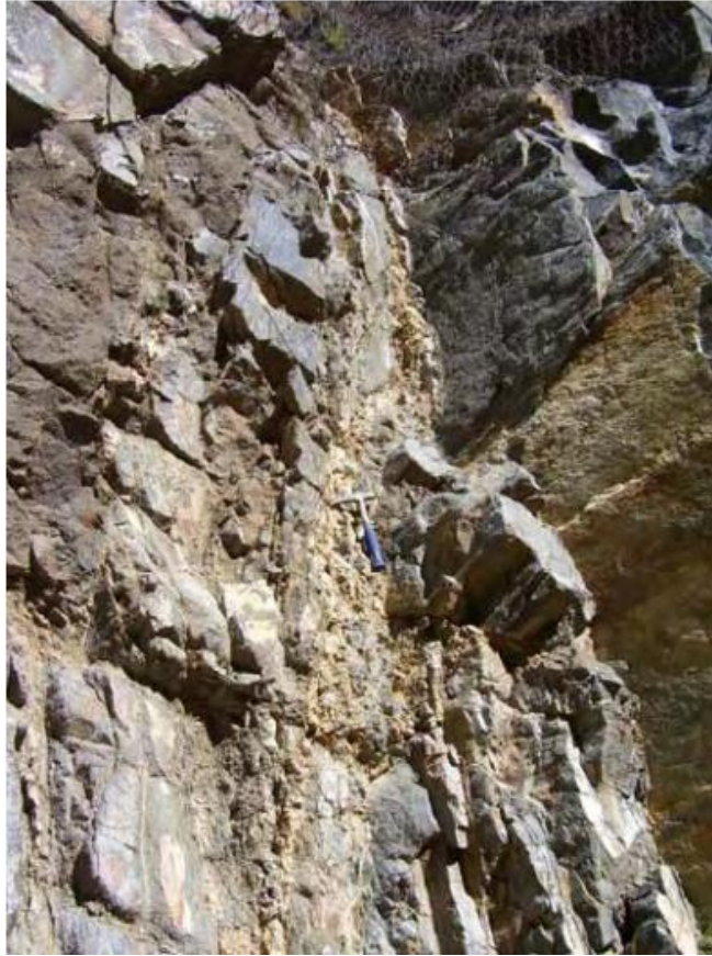
Slika 21. Stupanj uslojenosti – primjer 4.
