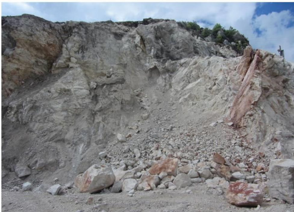
Slika 14. Primjer suhog pokosa ocijenjen s 3 boda
