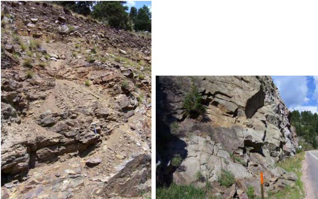
Slika 28. Diskontinuiteti - Stanje trošnosti kao parametar u diskontinuitetu stijenske mase
