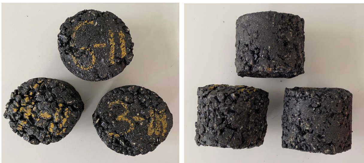
Slika 39: Uzorci nakon ispitivanja u Marshallovoj preši
