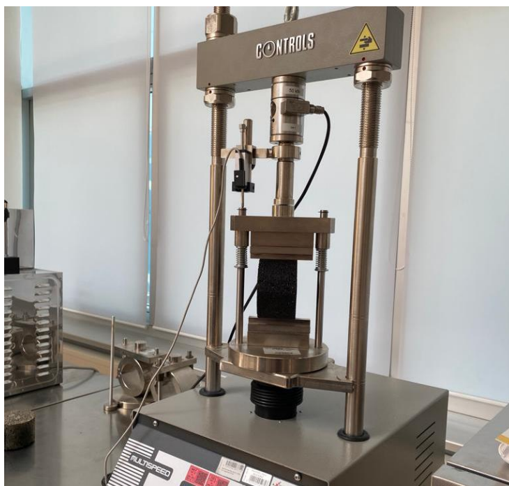
Slika 41: Ispitivanje neizravne vlačne čvrstoće
