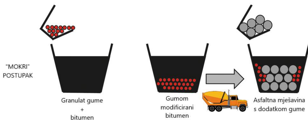
Slika 20: „Mokri“ postupak dodavanja granulata gume u bitumen [24]
