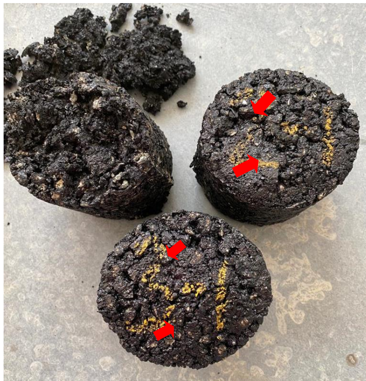
Slika 57: Uzorci s dodatkom gume nakon Marshallovog ispitivanja
