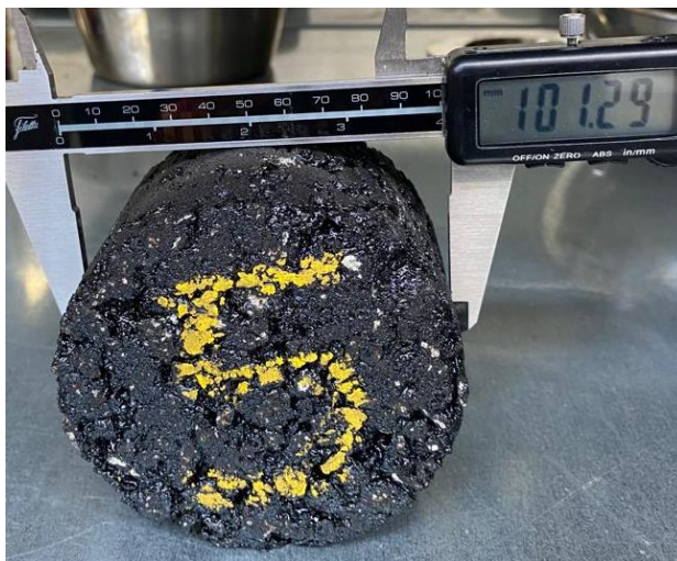
Slika 32: Mjerenje uzorka pomičnom mjerkom
