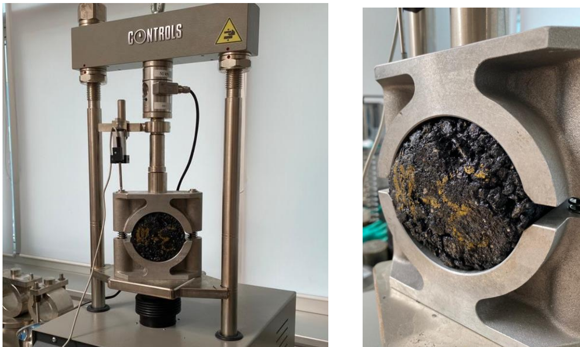
Slika 35: Ispitivanje uzorka u Marshallovoj preši
