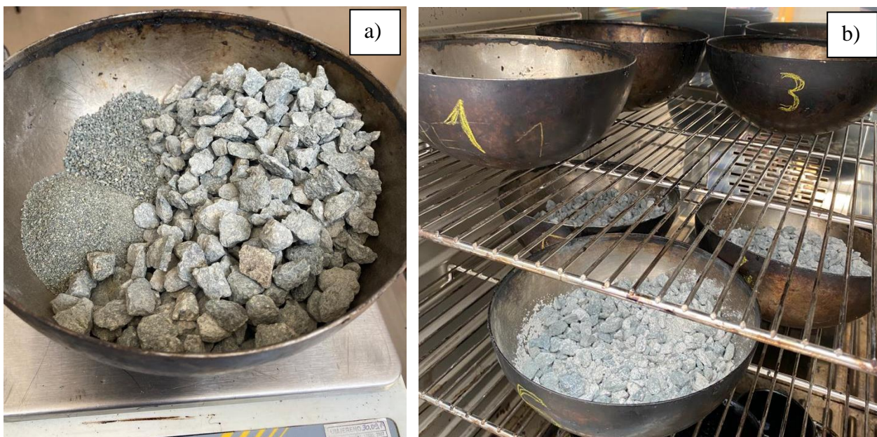
Slika 26: a) Kumulativno vaganje podfrakcija, b) Zagrijavanje materijala u pećnici
