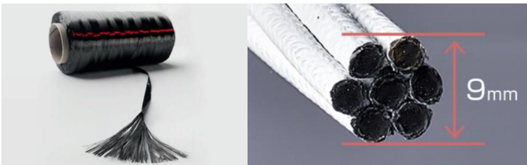
Slika 7 i 8: Proizvod od ugljičnih vlakana i njegov presjek [8]
