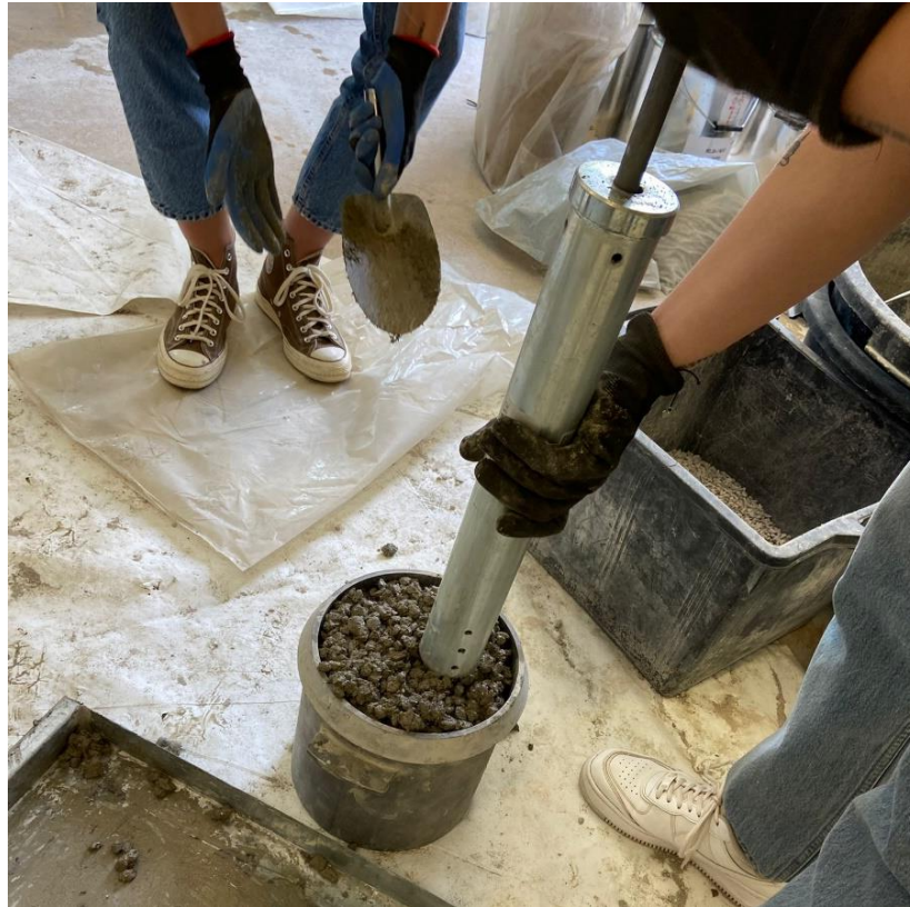
Slika 10 : Prikaz postupka zbijanja svježeg betona pomoću Proctorova čekića (izvor: vlastita fotografija)
