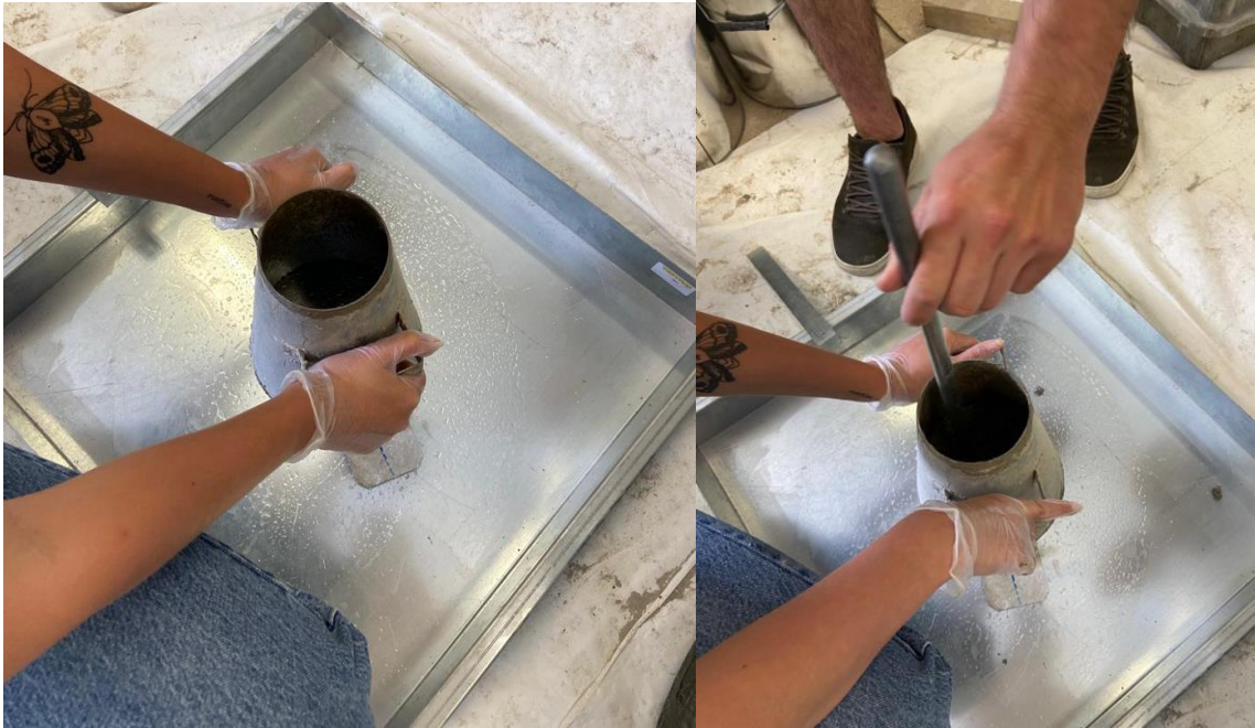
Slika 12 : Prikaz punjenja kalupa i zbijanje slojeva mješavine metalnom šipkom (izvor: vlastiti prikaz)
