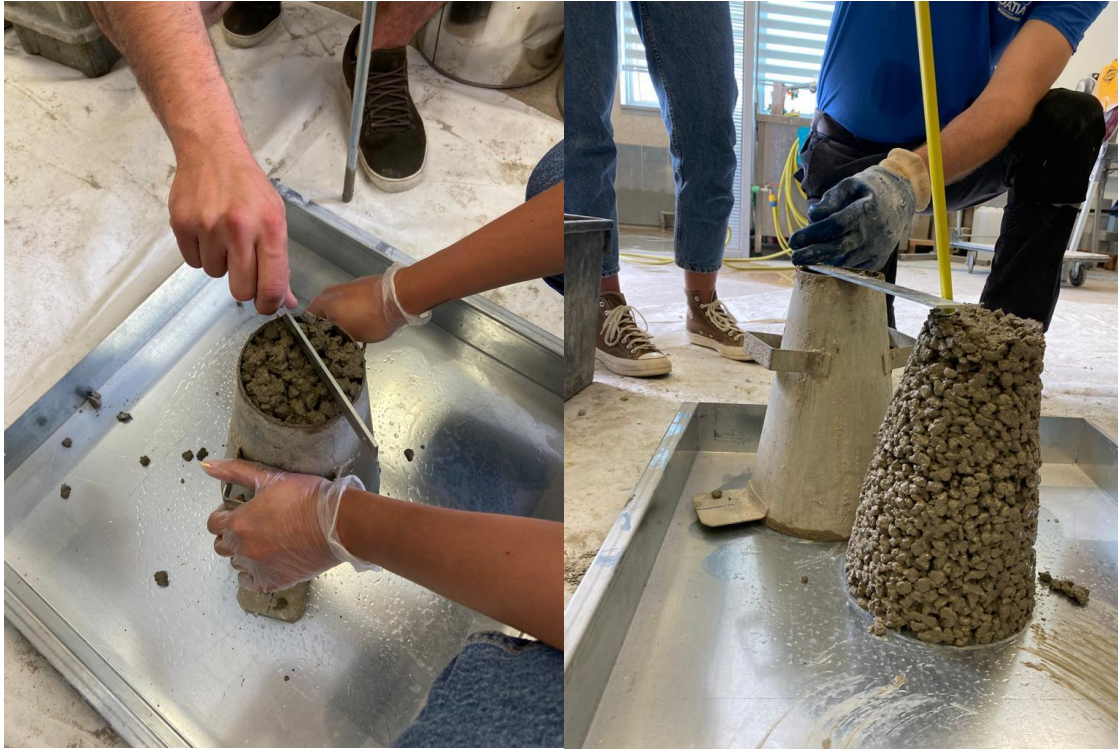
Slika 13 : Prikaz poravnavanja površine betona šikom i mjerenje slijeganja h (izvor: vlastiti prikaz)
