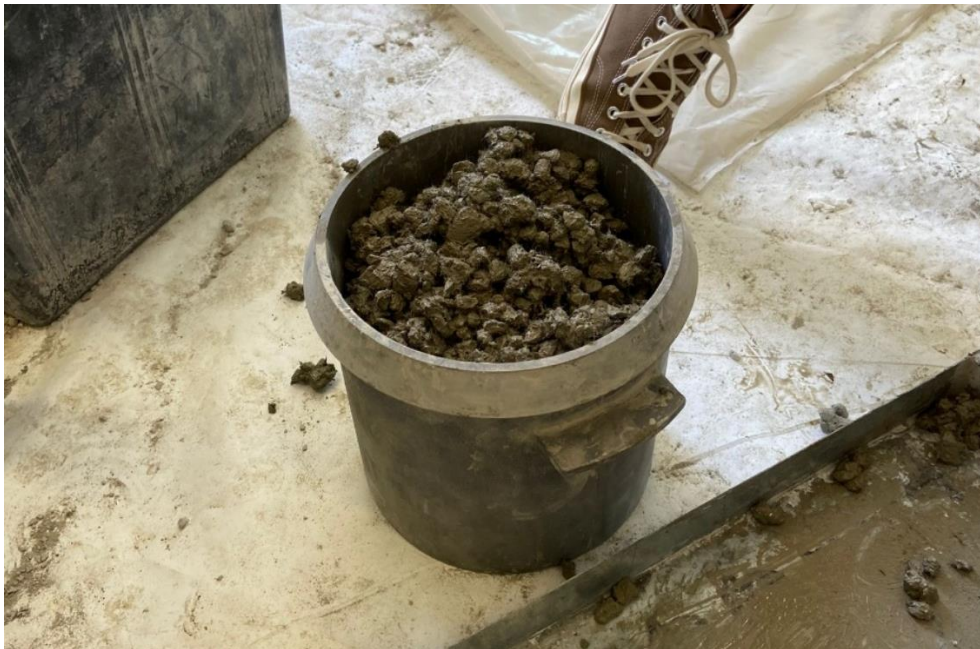
Slika 8 : Prikaz postupka punjenja posude u svrhu ispitivanja gustoće svježeg betona (izvor: vlastita fotografija)
