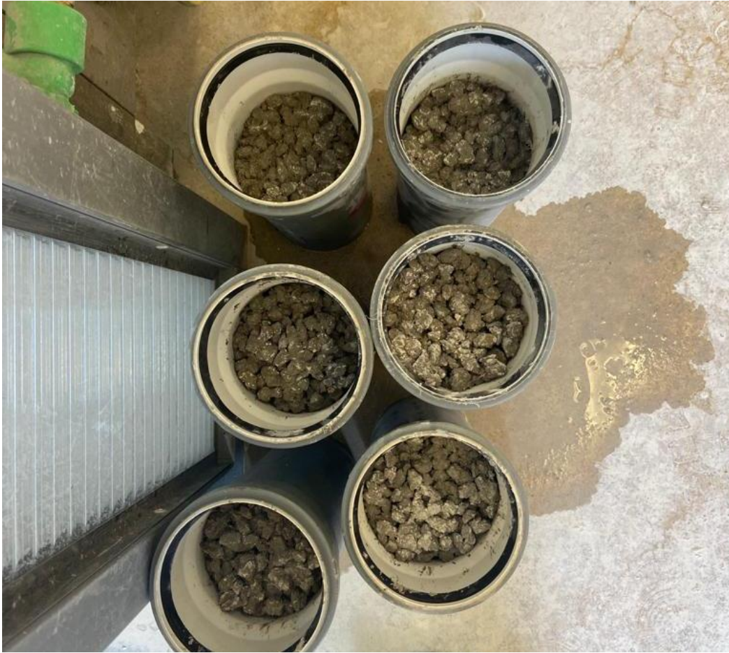
Slika 18 : Prikaz uzoraka betona u plastičnim cijevima (izvor: vlastita fotografija)
