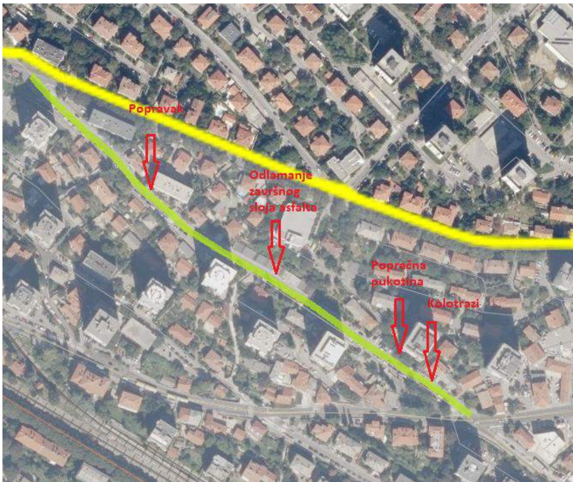
Slika 85: Ulica Krimeja i pozicije oštećenja
