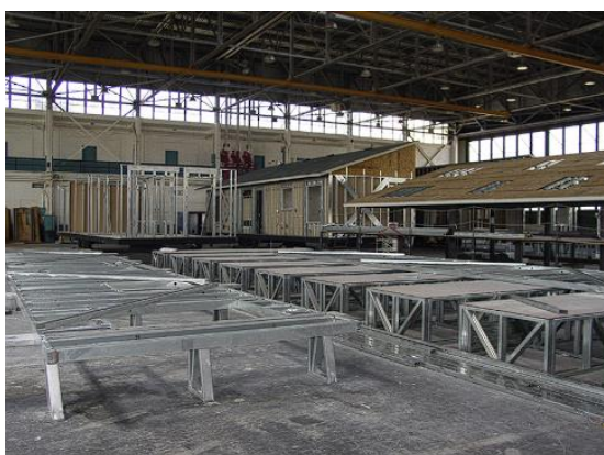
Slika 19: Proizvodnja panela u tvornici [1]
