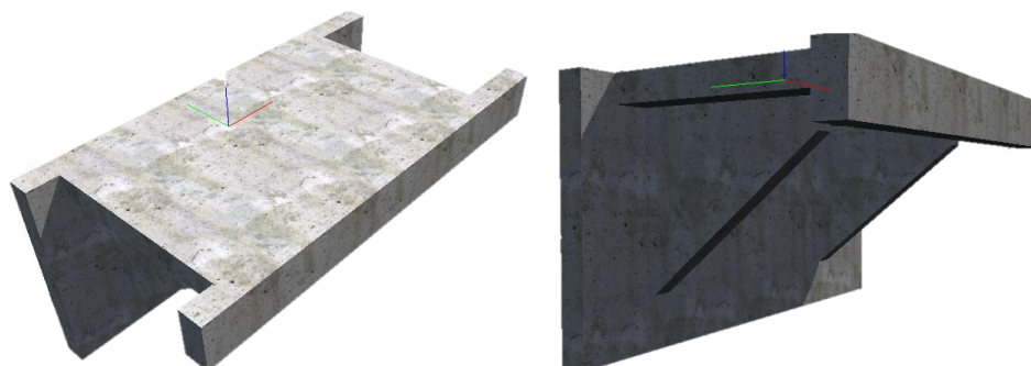
Slika 151. 3D prikaz valobranog ekrana tipa 5 (Izrađeno u Allplan-u)
