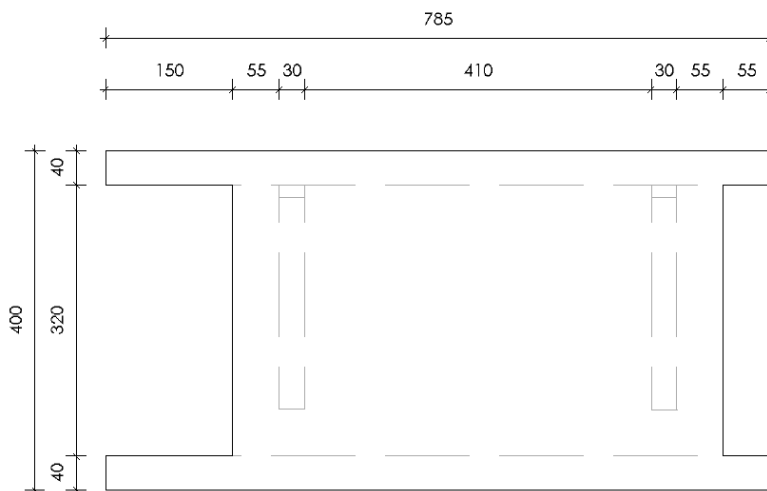
Slika 128. Dimenzije valobranog ekrana tipa 1 (Izrađeno u Allplan-u)
