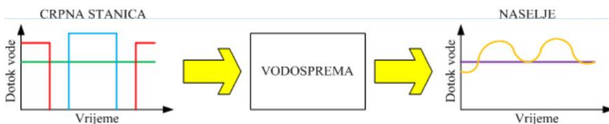
Slika 13: Shematski prikaz ulaza/izlaza vode u vodospremu [14]
