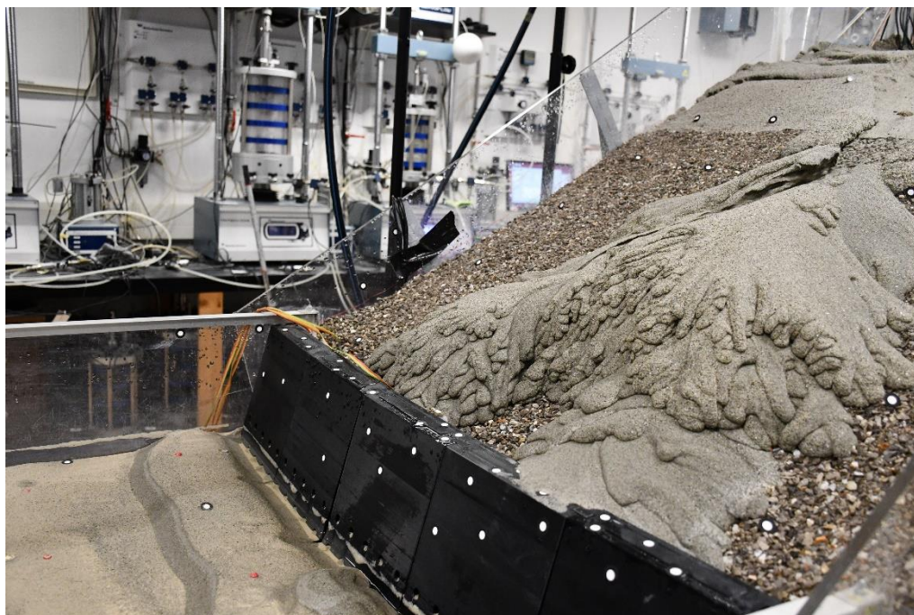
Slika 28: Uzdužna deformacija potpornog zida i izdignuti materijal u nožici
