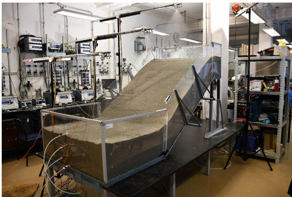
Slika 18: Početak ispitivanja - izlaganje modela umjetnim oborinama iz tri mlaznice
