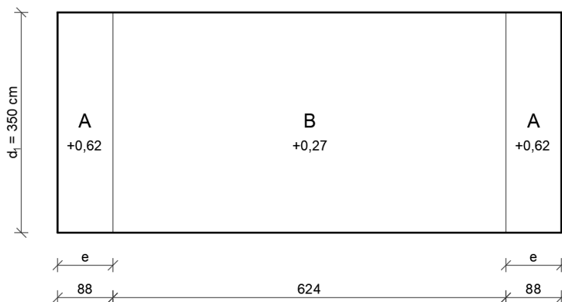
Slika 16: Djelovanje vjetra na nadstrešnicu (pozitivan smjer)
