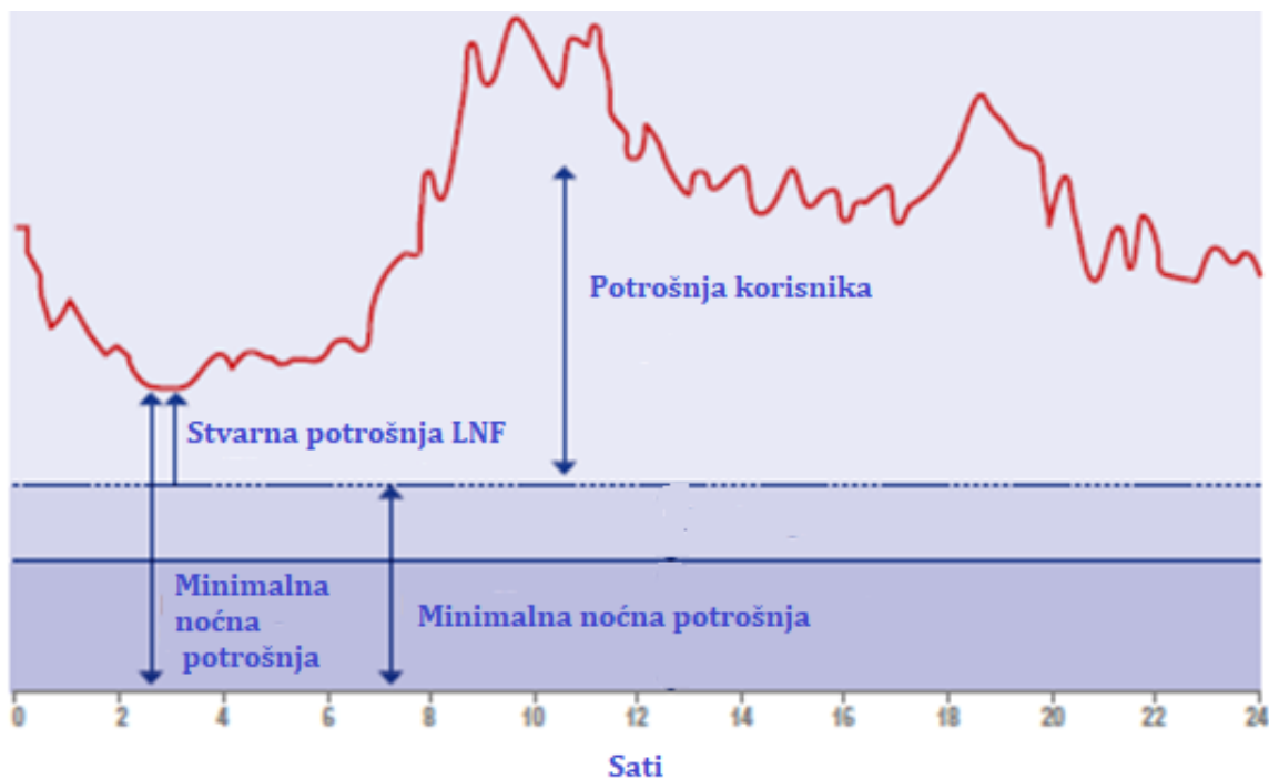
Slika 7. Prikaz minimalne noćne potrošnje, stvarne potrošnje i stvarnih gubitaka. Gubitak vode može se prikazati formulom: NNF (gubitak vode) = MNF (minimalna noćna potrošnja) - LNF (stvarna potrošnja).
