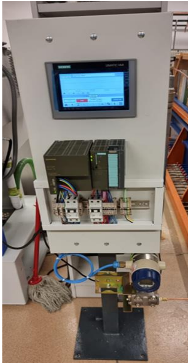
Slika 20. Mjerenje tlaka vode u laboratoriju građevinskog fakulteta Rijeka, Ulica Radmile Matejčić 3, Rijeka.
