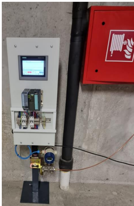
Slika 21. Mjerenje tlaka vode u podzemnoj garaži Učiteljskoh I Filozofskog fakulteta, Sveučilišna avenija 6, Rijeka.
