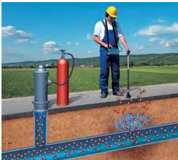
Slika 2.3 Lokalizacija gubitaka vode osluškivanjem vodoopskrbne mreže [3].
