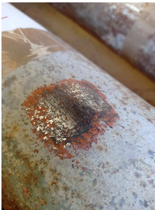
Slika 10: Prikaz mjernog mjesta pripremljenog za ispitivanje
