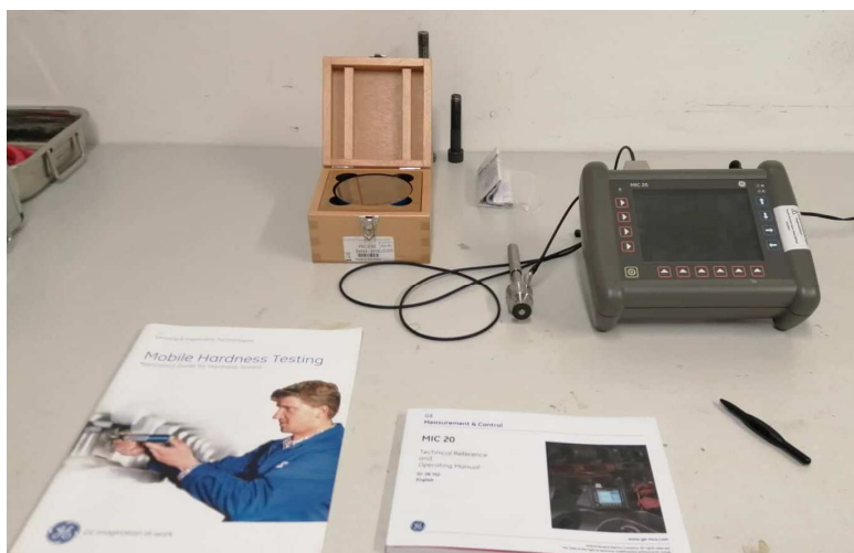
Slika 11: Prikaz opreme za umjeravanje uređaja
