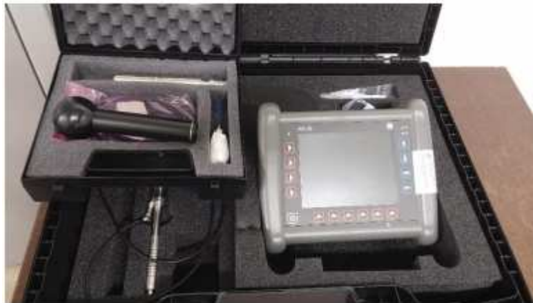
Slika 8: Prikaz osnovne opreme uređaja Krautkramer MIC 20 [10]
