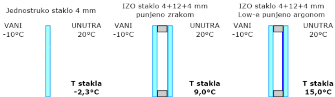
Slika 3. Utjecaj plemenitog plina i premaza na temperaturu stakla [8]
