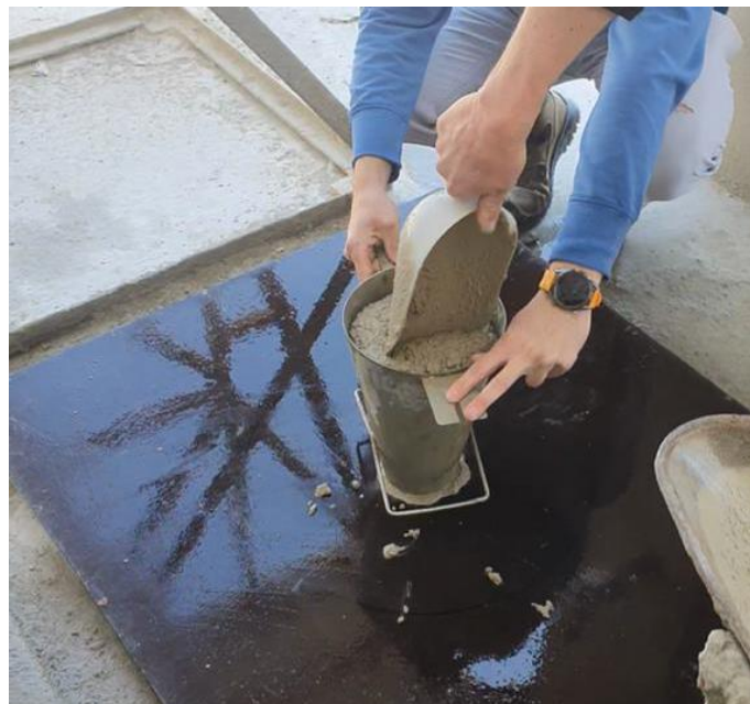
Slika 10: Priprema uzorka za ispitivanje konzistencije slijeganja rasprostiranjem
