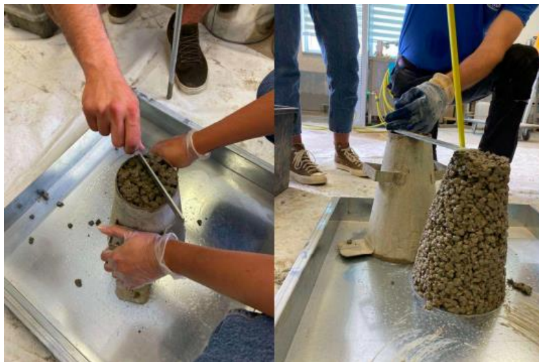
Slika 23: Postupak ispitivanja konzistencije procjedinog betona metodom slijeganja (izvor: vlastita fotografija)
