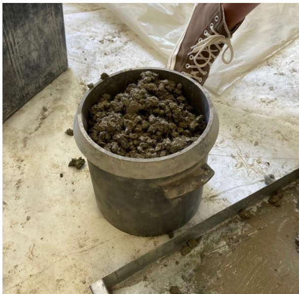
Slika 20: Postupak ispitivanja gustoće svježeg procjedinog betona (izvor: vlastita fotografija)
