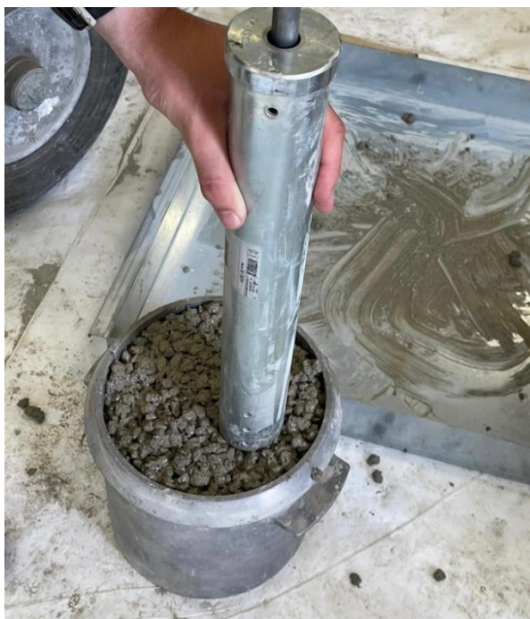
Slika 21: Postupak ispitivanja poroznosti svježeg procjdnog betona (izvor: vlastita fotografija)
