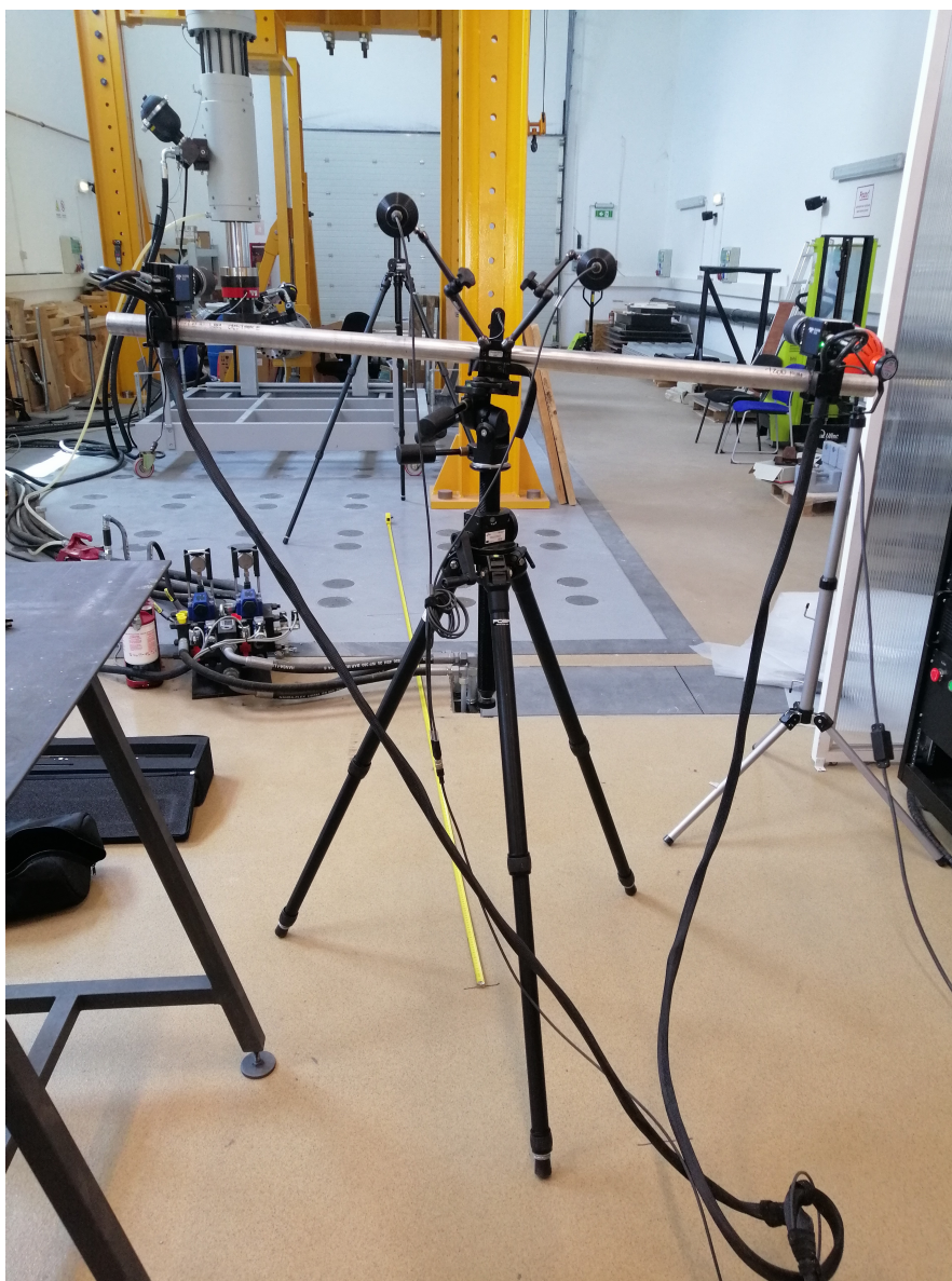
Slika 3.8: Optički mjerni sustav GOM mbH PONTOS 3D 4M
