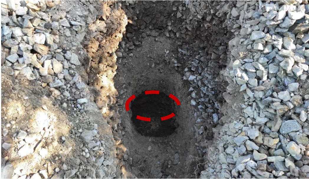
Slika 22. Naslage geotehničke jedinice 5 - Glinovitog šljunka u sklopu sondažne jame SJ-12 (Geotech d.o.o)
