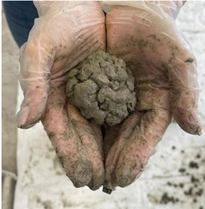
Slika 8: Ispitivanje konzistencije procjednog betona metodom kuglice (izvor: vlastita fotografija)
