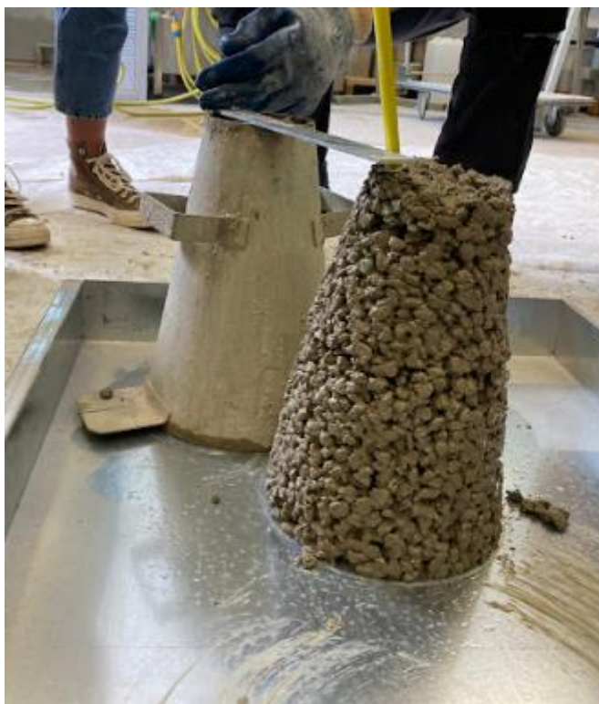
Slika 23: Mjerenje konzistencije slijeganjem (izvor: vlastita fotografija)
