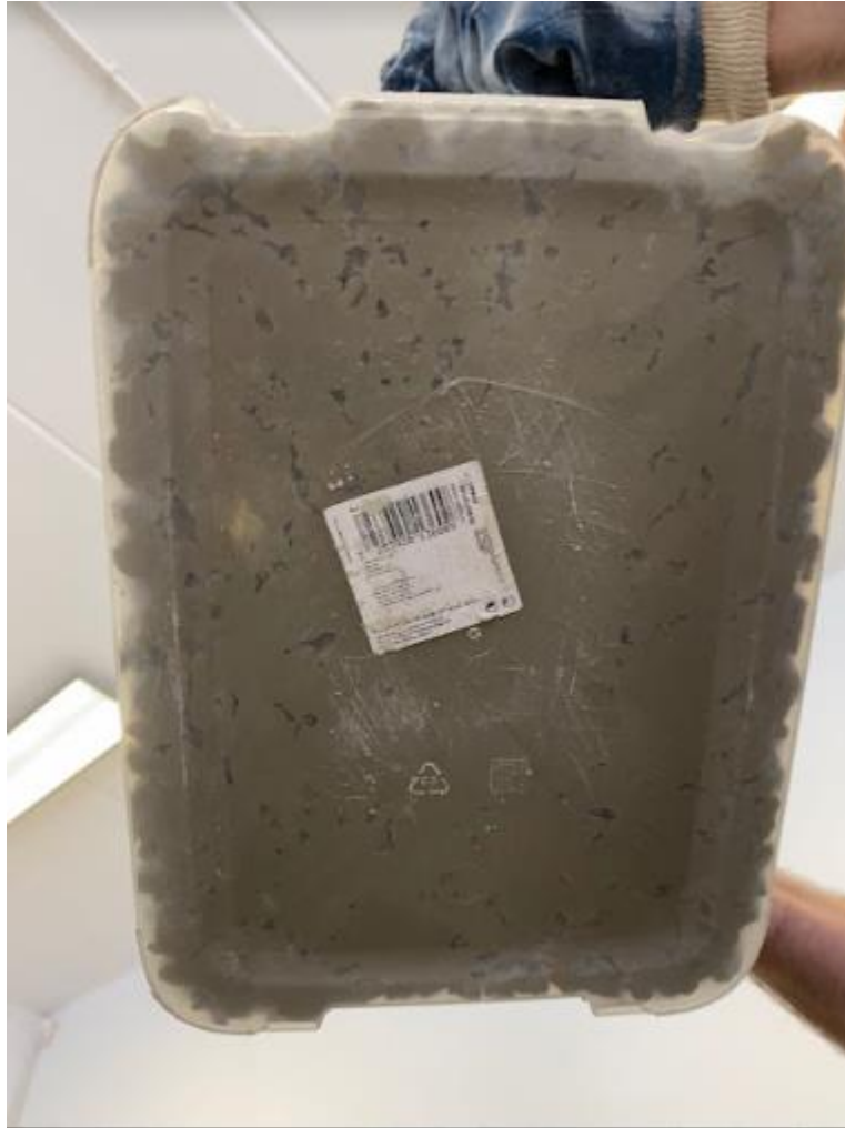
Slika 20: Izgled vibriranog uzorka procjdnog betona (izvor: vlastita fotografija)
