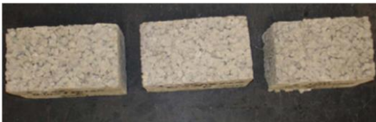
Slika 11: Testni uzorci za određivanje indeksa refleksije sunčeve svjetlosti [12]
