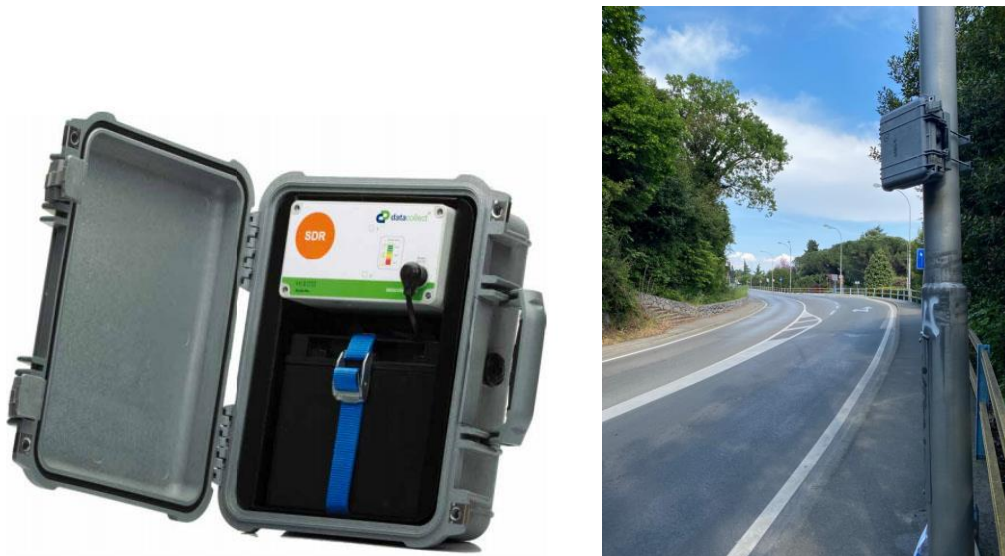
Slika 22: Izgled brojača Datacollect SDRtraffic+ i primjer postavljenog brojača u Opatiji
