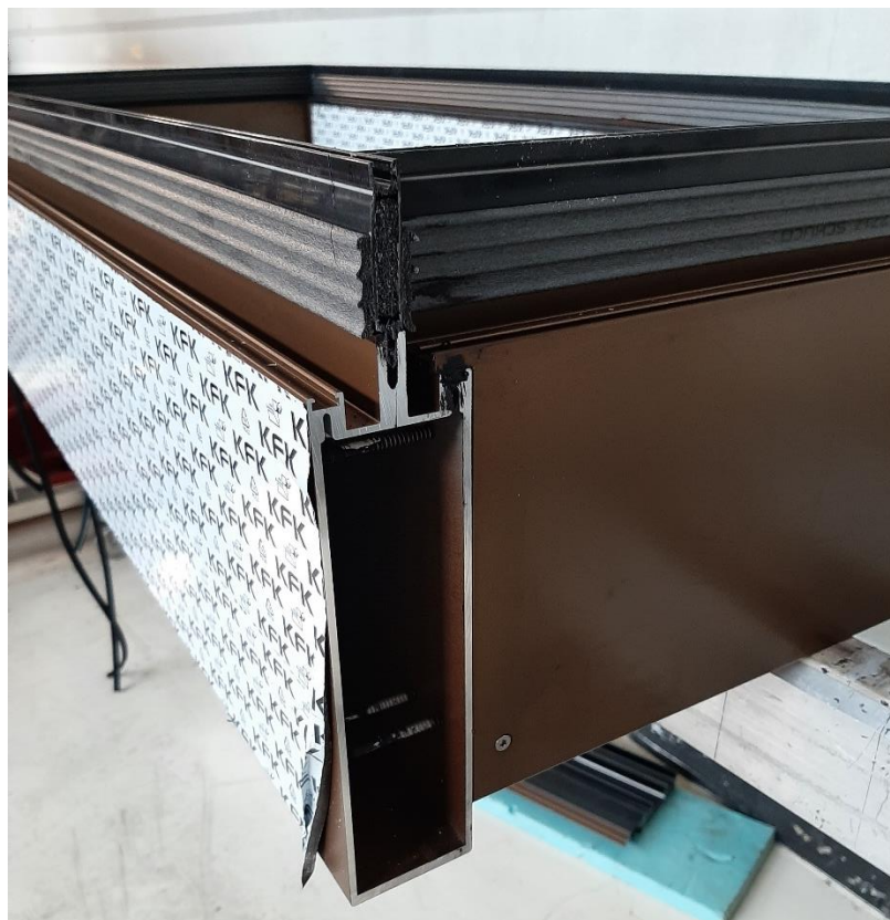
Slika 17. Okvir od aluminijskih profila
