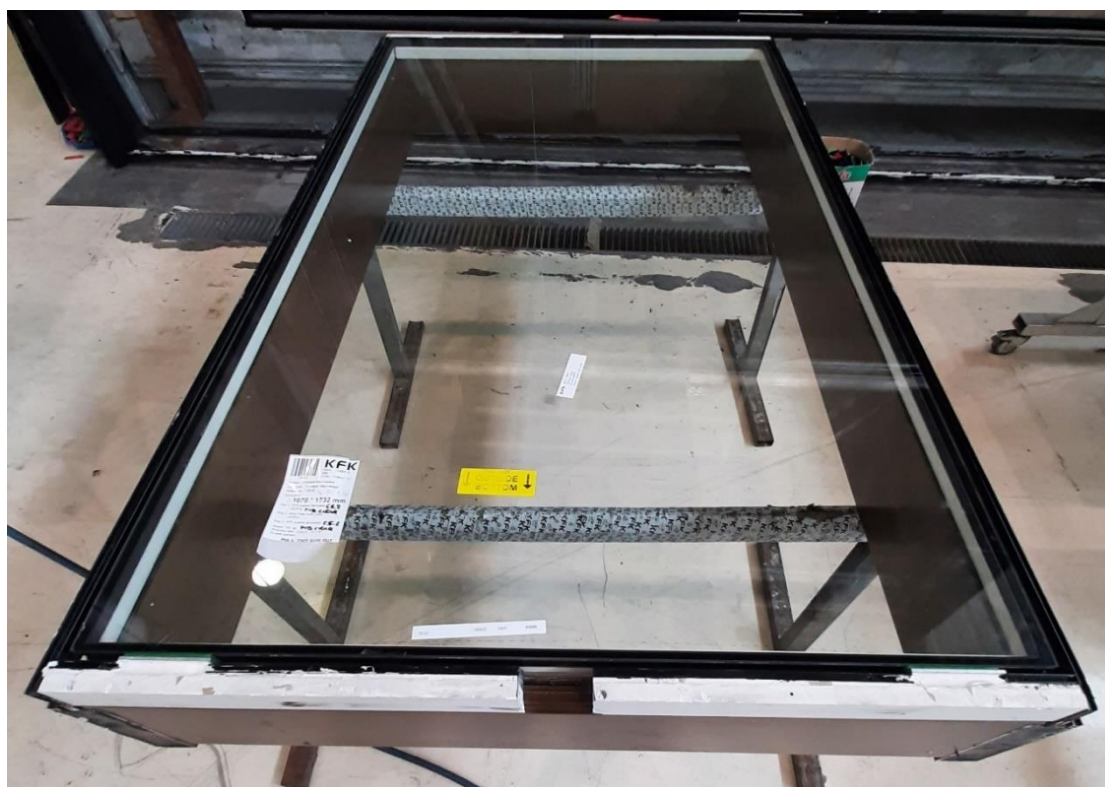
Slika 18. Izolacijsko staklo unutar okvira
