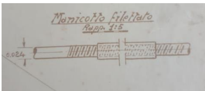
Slika 57: Mehanička spojnica armature u prstenu [4]
