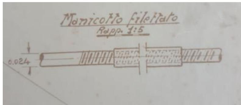
Slika 57: Mehanička spojница armature u prstenu [4]
