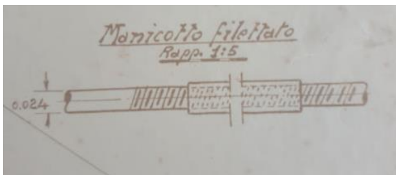
Slika 57: Mehanička spojnica armature u prstenu [4]
