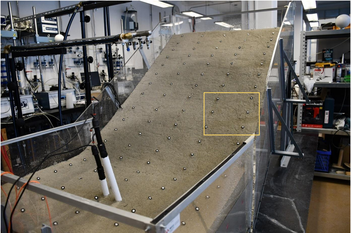
Slika 20: Pojava prve pukotine u modelu bez mjera sanacije
