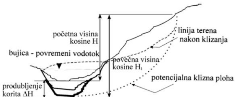
Slika 2. Povećanje razine vode uslijed erozije vodotoka [3]
