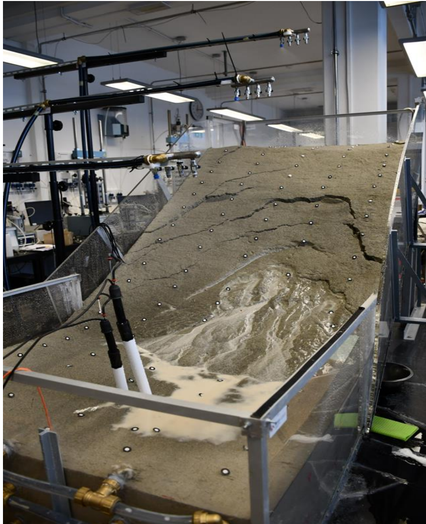
Slika 23: Gibanje kliznog tijela u modelu bez mjera sanacije ( t=120 min)
