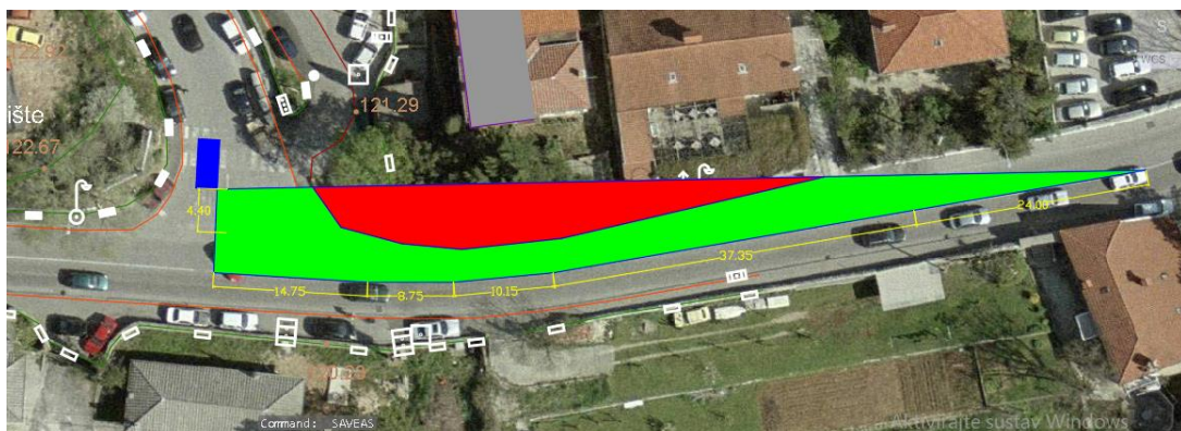
Slika 28: Duljina preglednosti za desne skretače prema US normi
