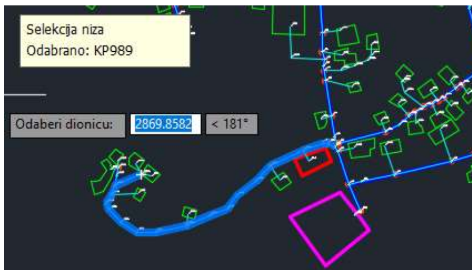
Slika 52: Odabir niza za crtanje uzdužnog profila u programu Urbano Hydra
