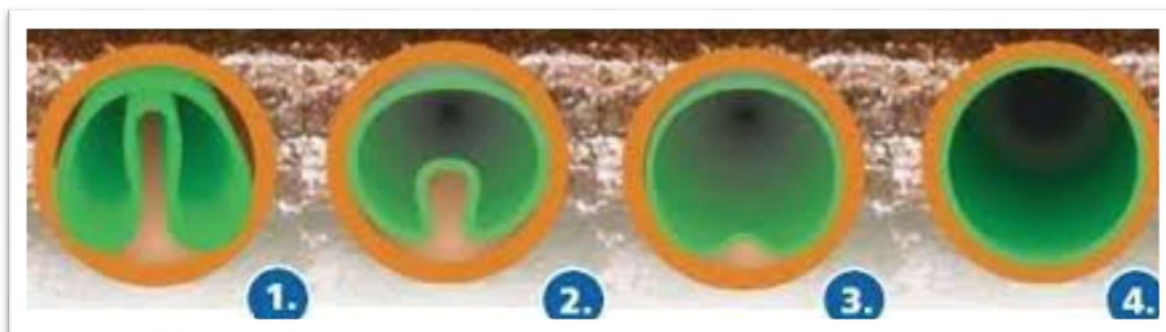
Slika 21 : Postupak ugradnje nove cijevi [5]
