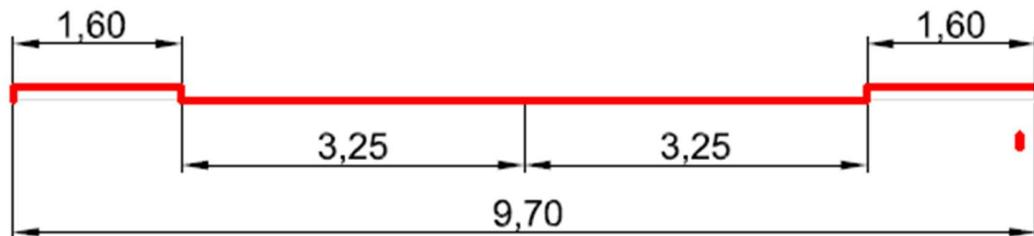
Slika 10: Poprečni presjek planirane ceste (Izvor: UPU Štinjan)
