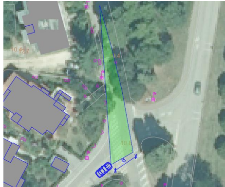
Slika 17. Provjera preglednosti na Ulici Anke Butorac
