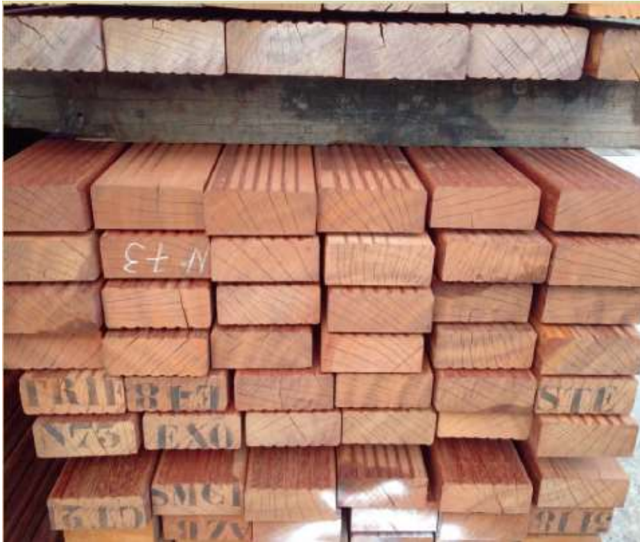
Slika 41: Drvene podnice bongosa (tzv. azobé) [3]
