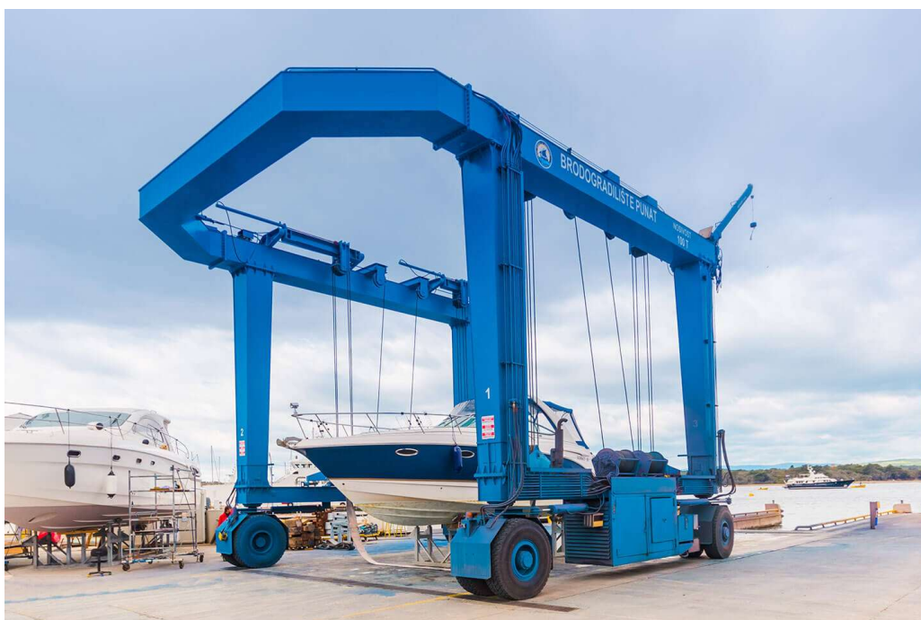
Slika 3: Izvlačenje plovila sa Travel liftom od 100 tona [13]
