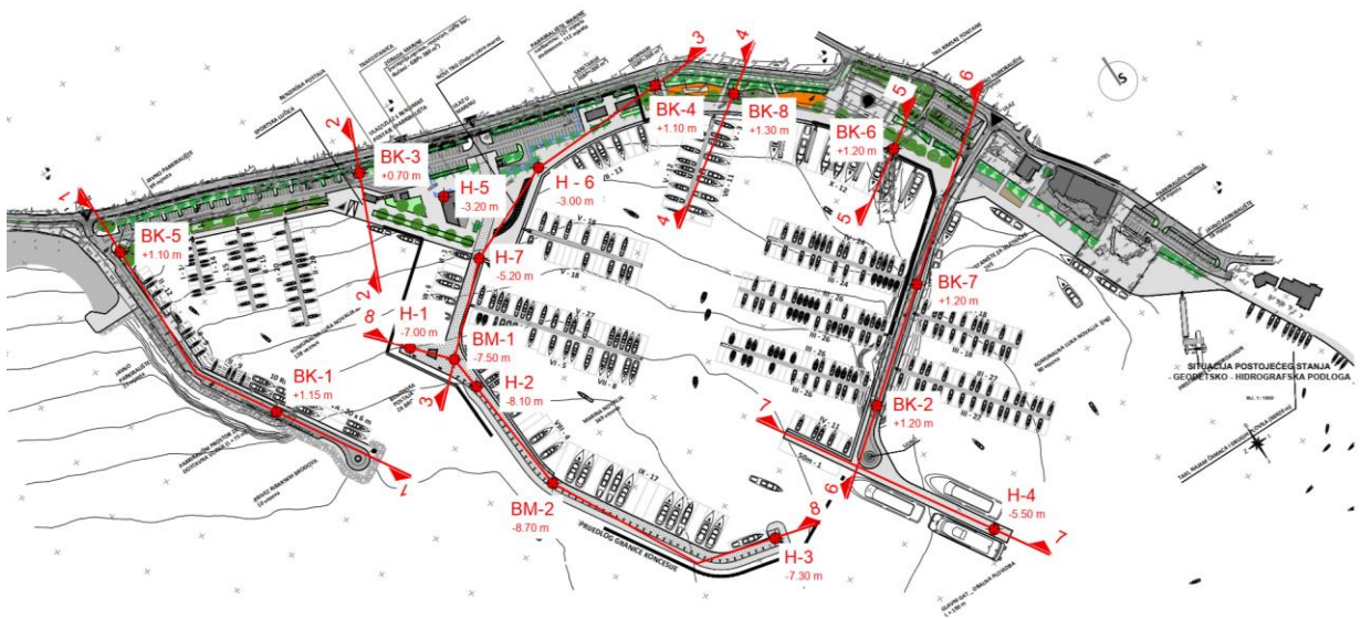
Slika14. Situacija s položajem istražnih bušotina [3]
