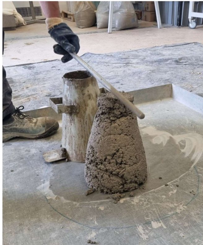
Slika 6: Ispitivanje konzistencije slijeganjem (izvor: vlastita fotografija)
