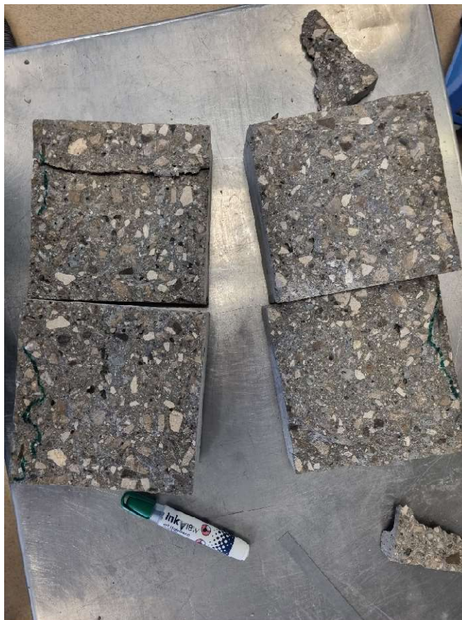
Slika 12: Označavanje dubine prodora vode (izvor: vlastita slika)
