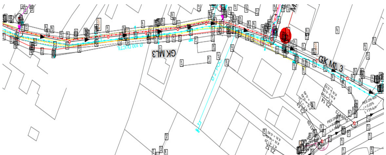
Slika 15. Rekonstrukcija vodovodnih instalacija glavnog kanala ML3 [6]
