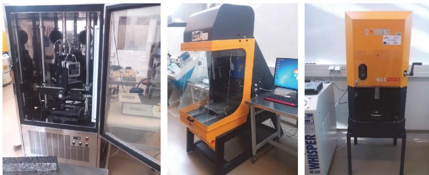
Slika 1. Uređaj za ispitivanje krutosti i zamora; valjkasti i kružni zbijlač
