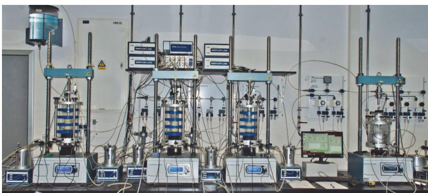
Slika 3. Sustav za troosno ispitivanje uzorka tla
